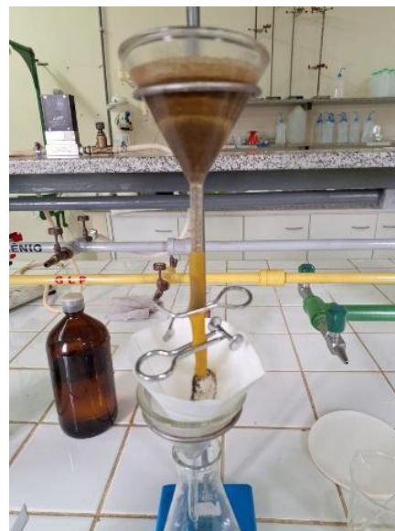
Figura 35 - Separação por meio denso, bromofórmio com grãos.
