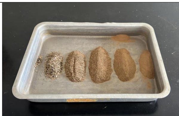
Figura 33 - Amostra separada nas malhas 35#, 60#, 80#, 100# e fundo.
