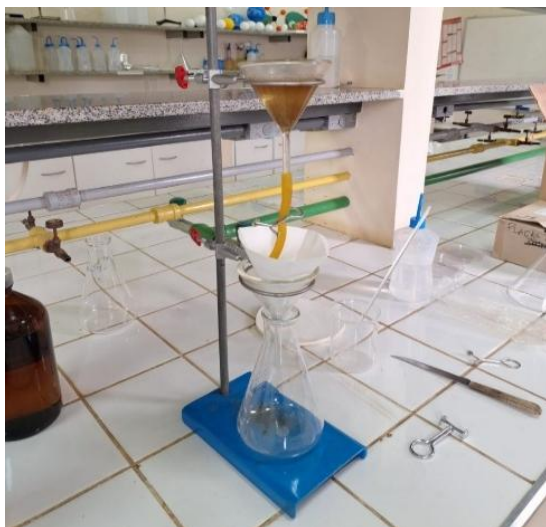
Figura 34 – Separação gravimétrica por meio denso com bromofórmio.
