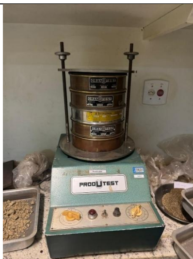
Figura 32 - Malhas 35#, 60#, 80#, 100# e fundo, no peneirador vibratório de bancada.
