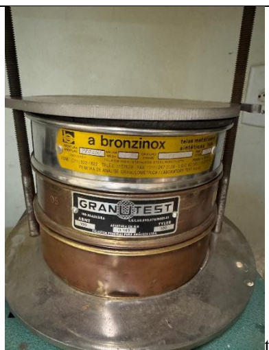
Figura 36 – Malhas 60#, 100# e fundo, no peneirador vibratório de bancada.
