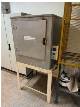
Figura 29– Estufa, realização da secagem das amostras coletadas.
