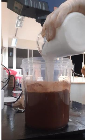
Figura 14 - Cola branca PVA não tóxica adicionada ao recipiente em agitação com rejeito e água.
