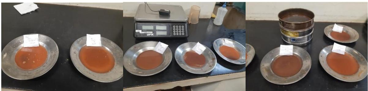
Figura 11 - Amostras retidas nas peneiras separadas em pratos e identificadas.
