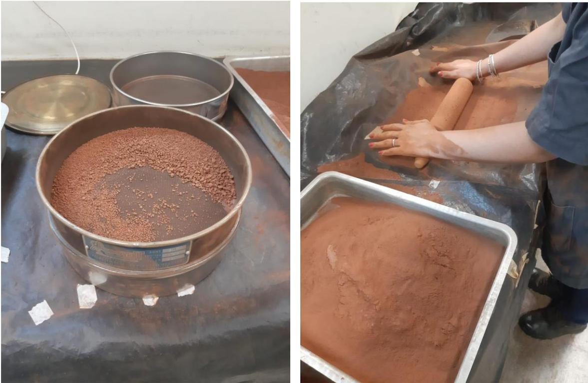
Figura 4 - Peneiramento na peneira de 28# e desaglomeração das partículas com o rolo.
