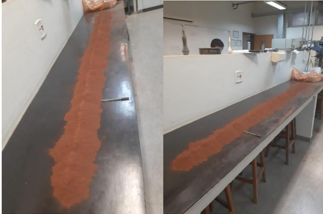
Figura 5 - Pilha alongada de 2,5 metros (250 cm).
