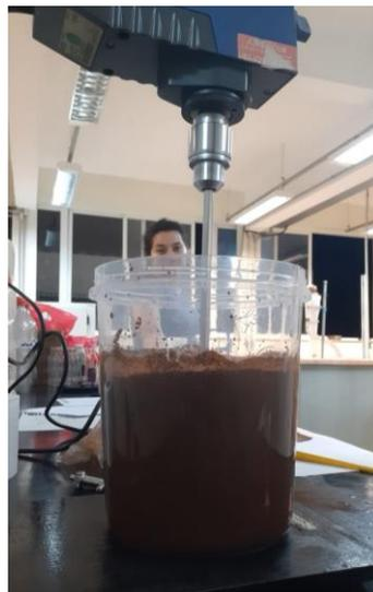
Figura 15 - Mistura de rejeito, cola e água em agitação até se tornar uma mistura homogênea.
