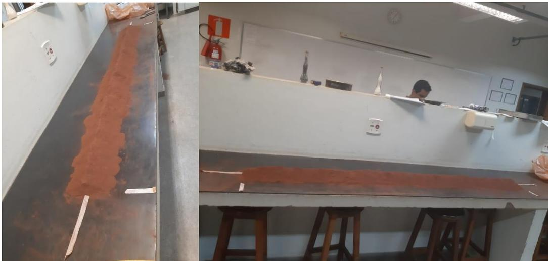
Figura 6 - Pilha alongada final com 2 metros (200 cm).
