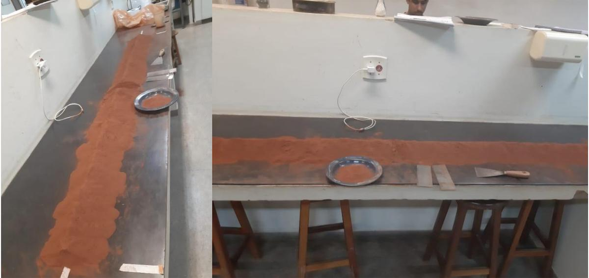
Figura 7 - Retirada das alíquotas de 100 g iniciando-se do centro da pilha alongada.
