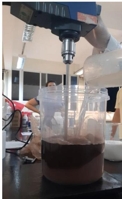
Figura 13 - Água adicionada ao recipiente com o rejeito.
