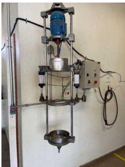
**Figura 14** - Série de peneiras utilizadas no peneirador suspenso.
