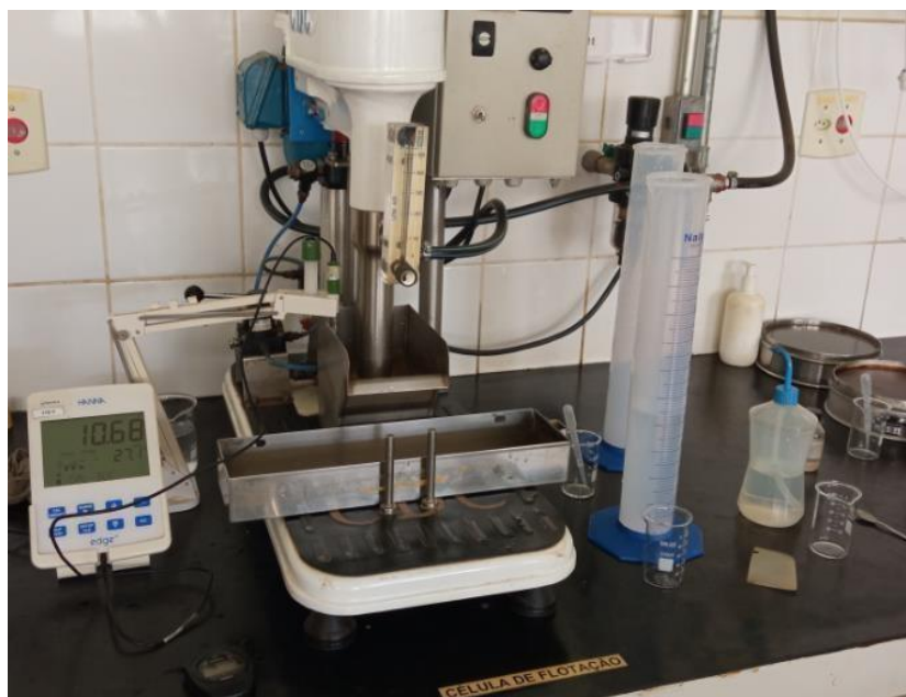
Figura 29 - Equipamentos utilizados nos testes de flotação
