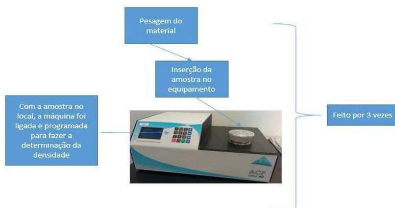
Figura 20 - Passos para obtenção da densidade do minério
