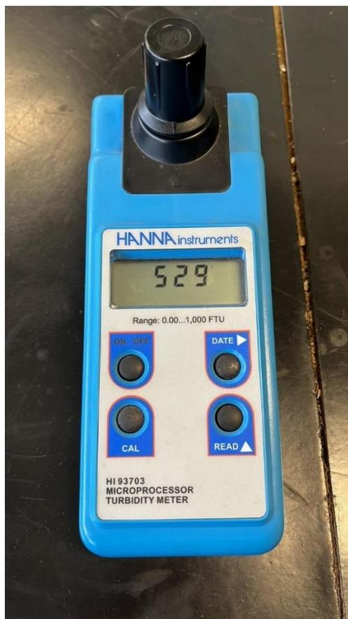
**Figura 3.4:** Instrumento Turbidímetro.
