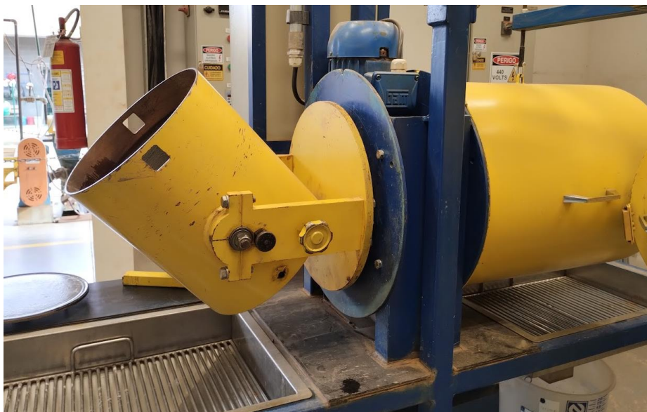
Figura 8: Moinho usado na cominuição do rejeito fosfático
