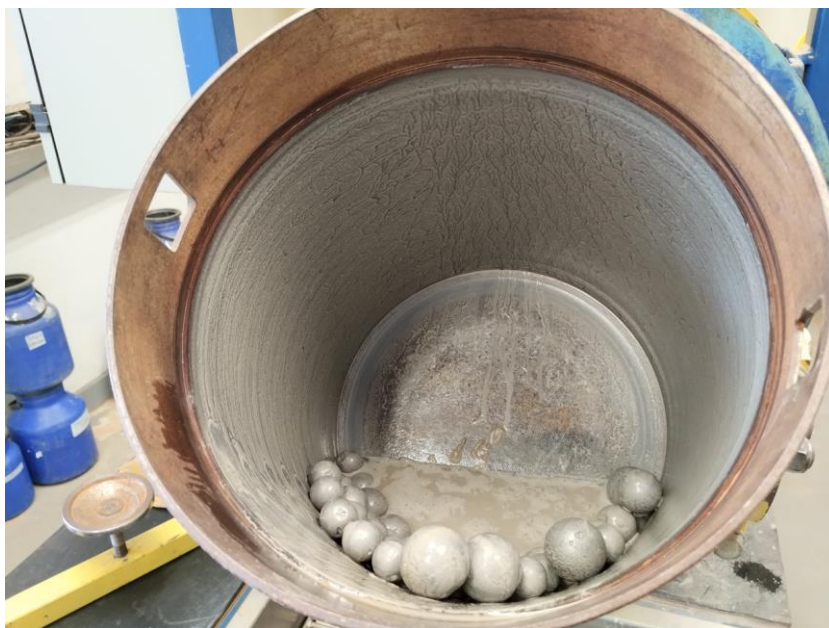
Figura 9: Vista interna do moinho empregado na moagem do rejeito scavenger .
