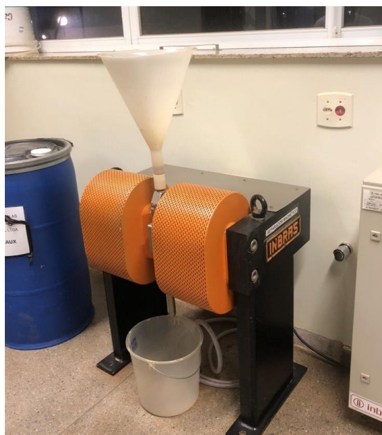
Figura 11: Vista do separador magnético de alto campo.
