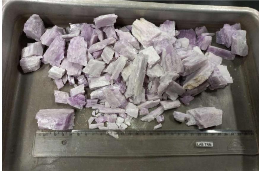
Utilizando uma barra metálica e a carcaça do moinho de jarro de metal (Figura 15), reduziu-se a granulometria mineral até que o mesmo fosse passante em 4# (4,76 mm), pois a granulometria de alimentação da moagem, geralmente, está no intervalo de  $\frac{1}{4}$ " a 1" (OLIVEIRA *et al.*, 2020). Sendo assim, primeiro fragmentou-se o material, depois o material foi peneirado e por fim, o material retido em 4# era cominuído novamente.
