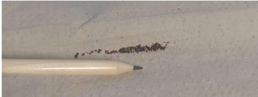
Para realizar a fragmentação manual, primeiramente pesou-se a amostra inicial proveniente de uma mina de Araçuaí, Minas Gerais (Figura 13). Subsequente a isso, fragmentou-se o material com o martelo até atingir uma granulometria menor, conforme Figura 14.
