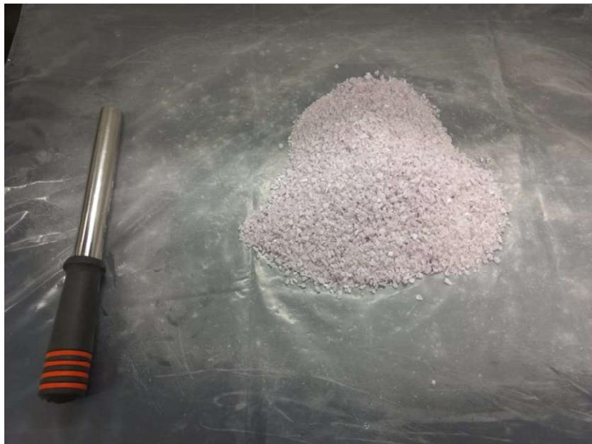
Finalizado a limpeza, realizou-se a homogeneização do material por pilha alongada para a retirada de 3 alíquotas utilizadas para a microscopia óptica e para o peneiramento a seco, além de utilizar uma fração da massa para a picnometria.
