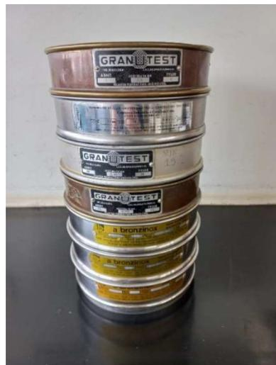
Para realizar o peneiramento a úmido, colocou-se a série de peneiras no peneirador suspenso e despejou-se a polpa. O peneiramento só foi finalizado, ao perceber que a água estava incolor, indicando que não havia partículas inferior a 400# (0,037 mm).
