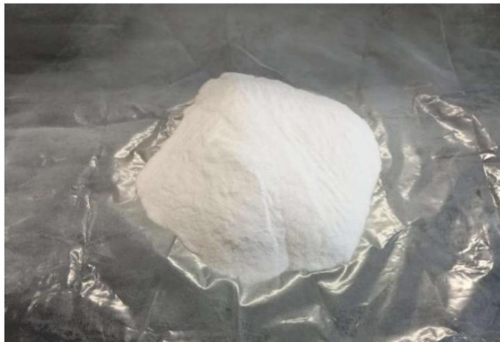
Após homogeneização do material por pilha cônica, retomou-se o material e o homogeneizou por pilha alongada, retirando-se 10% de cada extremidade da pilha, retomando e redistribuindo ao longo da pilha. Sendo assim, retirou-se 2 alíquotas, sendo uma destinada ao DRX e outra destinada ao FRX, conforme Tabela 5.
