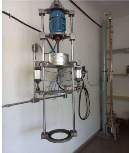
Além de realizar o peneiramento do material inicial, antes de ser moído, realizou-se o peneiramento a úmido do material após cada processo de moagem. Portanto, definiu-se a série de peneiras a serem utilizadas nesse processo, sendo elas, as peneiras de 6#, 16#, 35#, 65#, 100#, 200# e 400# (Figura 23).
