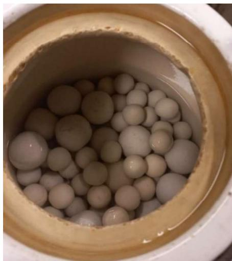
Ao definir a massa de sólidos e a massa de água, inseriu-se as bolas no moinho e adicionou-se a massa de sólidos e a massa de água. Em seguida, fechou-se o moinho e o colocou sobre os rolos para realizar a moagem, durante 50 minutos. Além disso, acionou-se o cronômetro calcular a velocidade do moinho. Para isso, cronometrou-se o tempo que o moinho necessitava para dar 10 voltas e fez-se uma regra de três para saber a quantidade de rotações por minuto do moinho.
