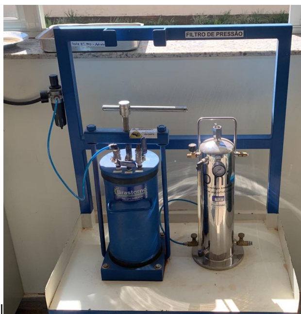
Figura 17: Unidade de Filtragem a Pressão.
