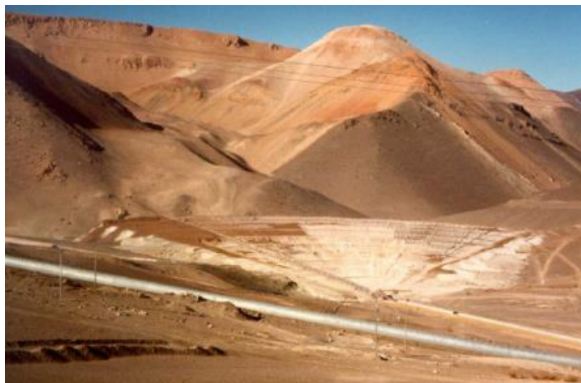
Figura 7: Empilhamento de rejeitos em La Coipa.
