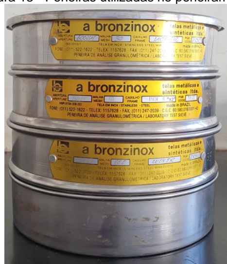
Figura 13 - Peneiras utilizadas no peneiramento.
