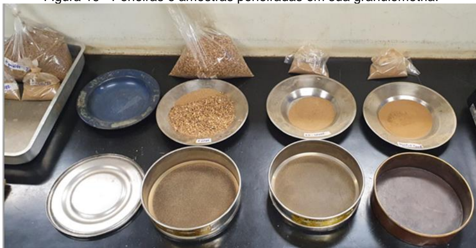
Figura 16 - Peneiras e amostras peneiradas em sua granulometria.
