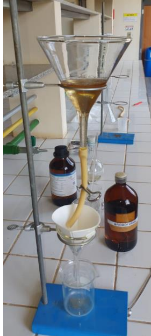
Figura 20 - Realização da concentração gravimétrica.
