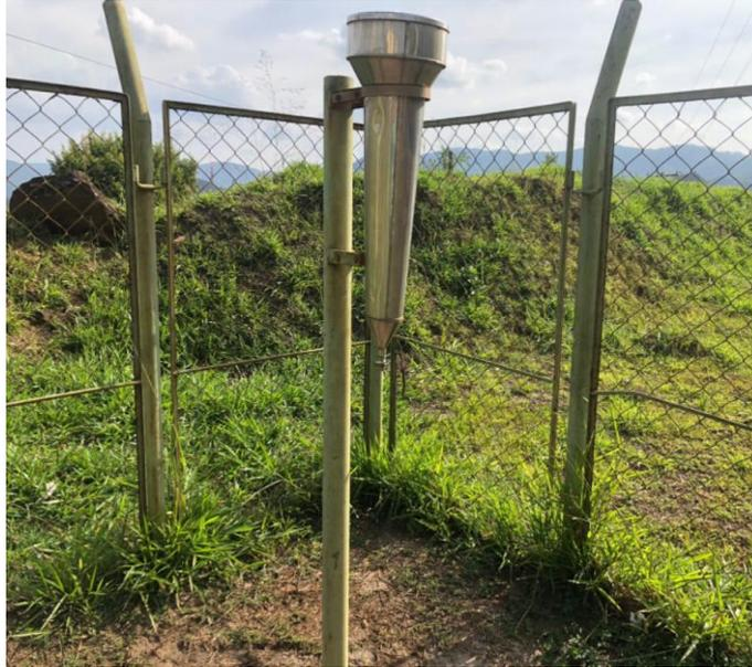
Figura 2.7 - Pluviógrafo
