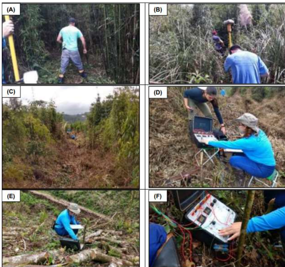
Figura 13 - Abertura das picadas para execução das linhas geofísicas (A e B); aquisição dos dados geofísicos na LG-1 (C e D); aquisição dos dados geofísicos na LG-2 (E); e resistivímetro utilizado durante o levantamento (F)
