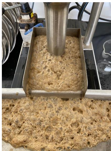
Figura 23 - Coleta do concentrado na flotação de bancada.
