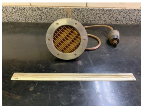
Figura 25 - Folha de teste com a placa ranhurada de drenagem.
