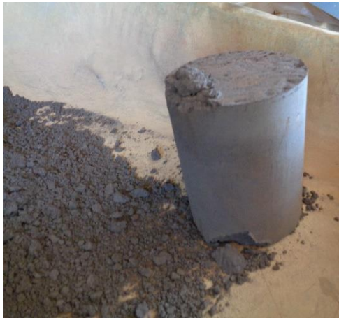
Figura 23 - Massa úmida de rejeito compactado retirado do cilindro de Proctor em um dos testes realizados.
