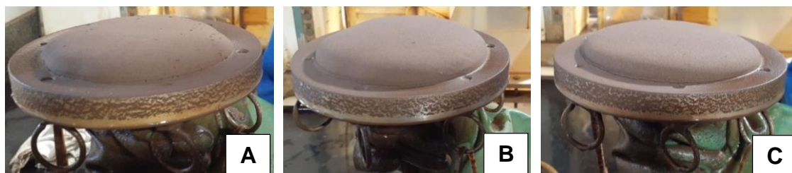
Figura 38 - Tortas produzidas ao dosar o sistema com solução de R-1687 a 10 g/t (A), 55 g/t (B) e 100 g/t (C).
