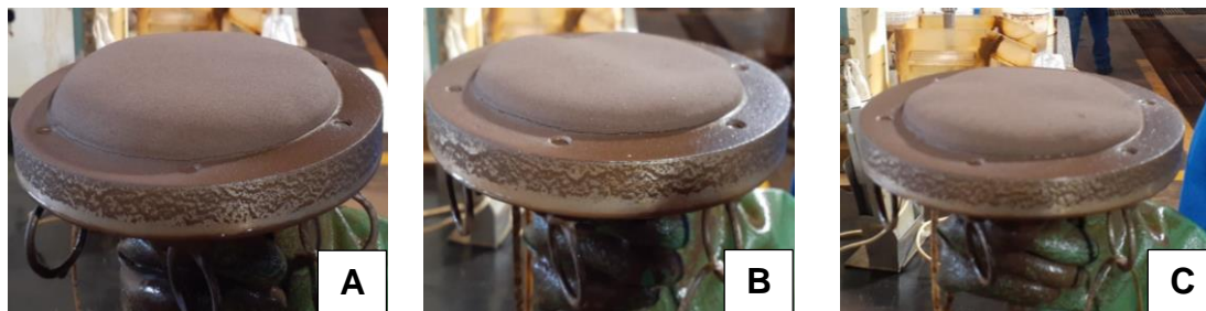
Figura 40 - Tortas produzidas ao dosar o sistema com solução de sulfato de alumínio a 10 g/t (A), 55 g/t (B) e 100 g/t (C).
