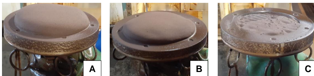
Figura 36 - Tortas produzidas ao dosar o sistema com solução de R-1607 a 10 g/t (A), 55 g/t (B) e (C) 100 g/t.
