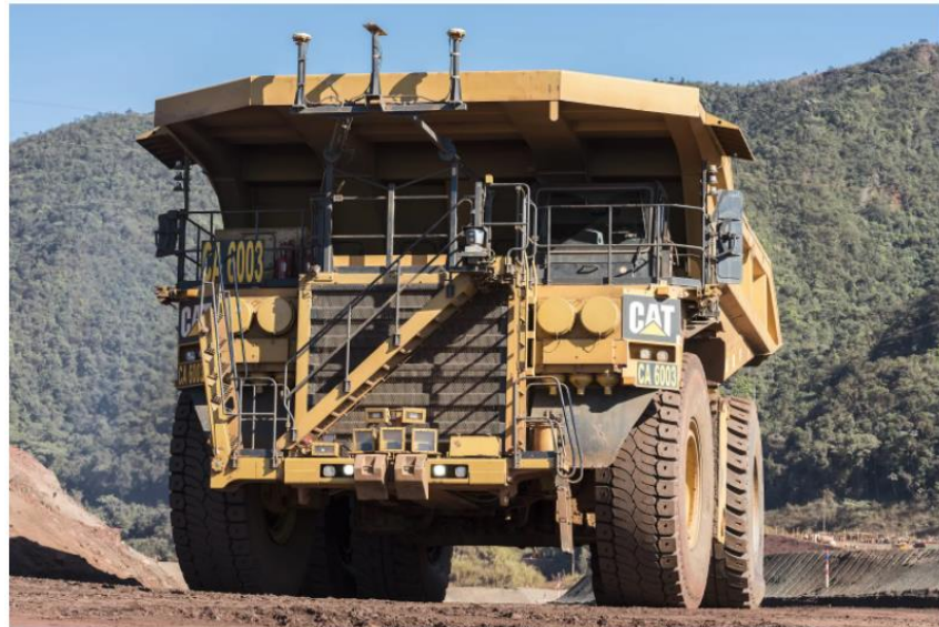
Figura 5: Caminhão autônomo da Vale de Brucutu em Minas Gerais.
