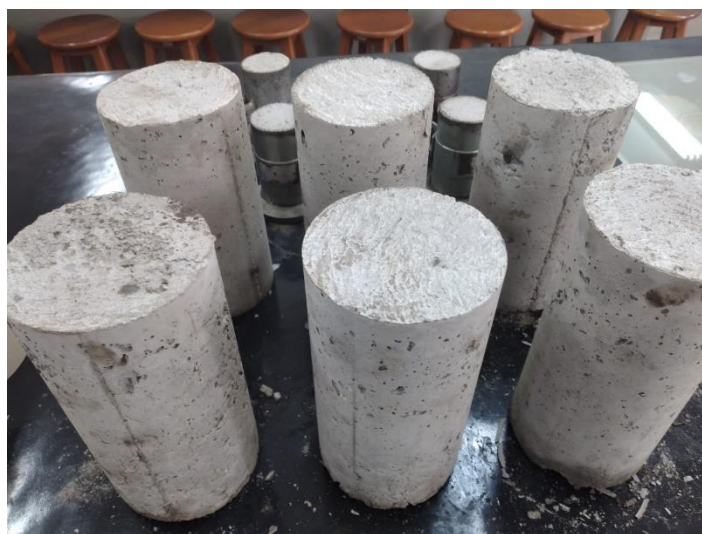
Figura 17 – Confeção dos corpos de prova de referência
