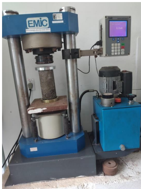
Figura 19 – Ensaio de resistência à compressão
