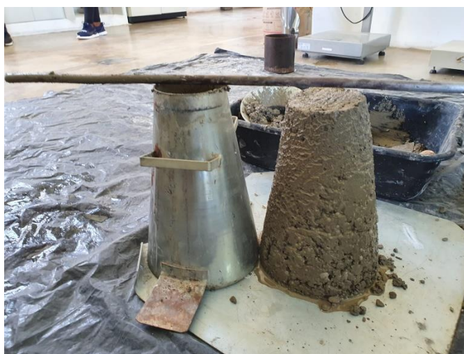
Figura 18 – Determinação da consistência pelo abatimento do tronco de cone (concreto de referência)
