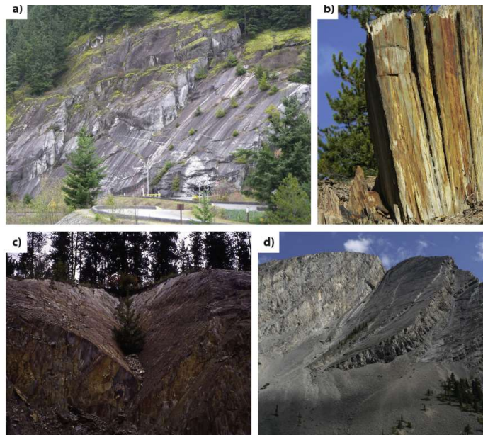
Figura 4 Principais modos de ruptura de rochas considerados na análise de estabilidade de taludes: a) ruptura planar, b) tombamento e c) ruptura em cunha. d) Falha translacional multiplanar.
