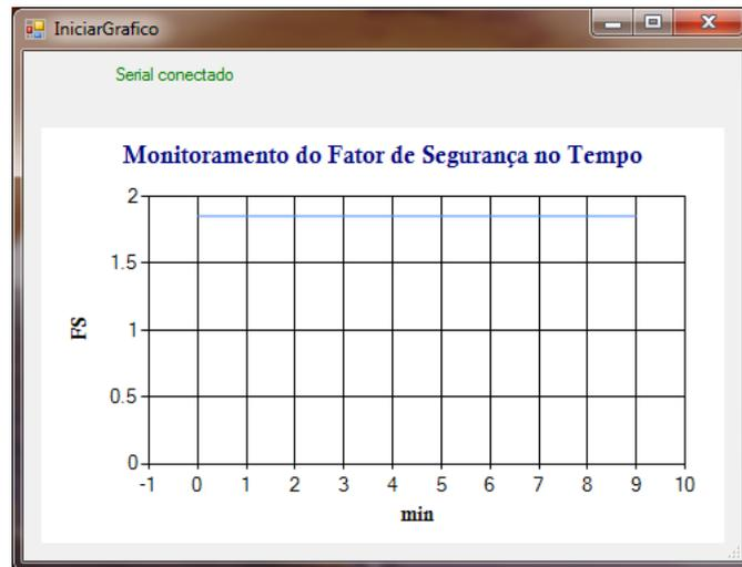
Logo após, realizou-se o teste com 20mm, a Figura 32 traz o gráfico plotado. É perceptível que com o aumento do volume de chuva infiltrado o FS é reduzindo chegando, nesse caso, a aproximadamente 1,66.
