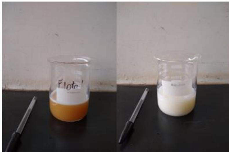
Após a pesagem dos reagentes, misturou-se o óleo, água e o NaOH. A mistura foi agitada em agitador magnético, da marca Hanna *Instruments* por 10 minutos. Após esse período, foi adicionado água de diluição e foi agitado por mais 10 minutos. Todo o procedimento foi acompanhado com cuidado para que não houvesse formação de espuma. As soluções foram preparadas com concentração à 2,5% m/m de óleo e relação óleo:soda 7:1.
