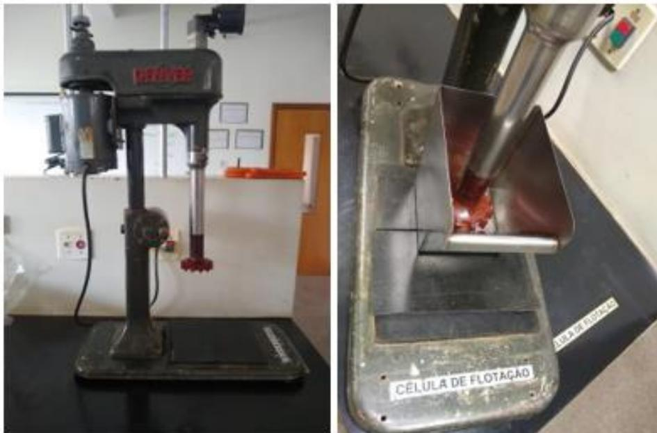
Dessa forma, foi promovido o contato dos reagentes com a superfícies das partículas, realizando o condicionamento da polpa, a 50% de sólidos. Para isso, a cuba foi alimentada com minério e água e, logo após, o rotor foi ligado. Adicionou-se o depressor e o condicionou por 5 minutos. Após esse tempo, adicionou-se o coletor, e o condicionou novamente por mais
