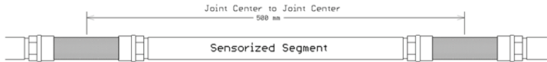
Figura 14 - Seção sensorizada Shape Array Accelerometer.
