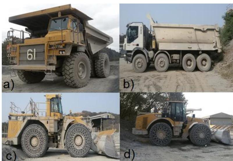
Figura 11 - Conjunto de equipamentos de carga e transporte. (a) Caterpillar 775; (b) Iveco; (c) Caterpillar 990; (d) Caterpillar 980.
