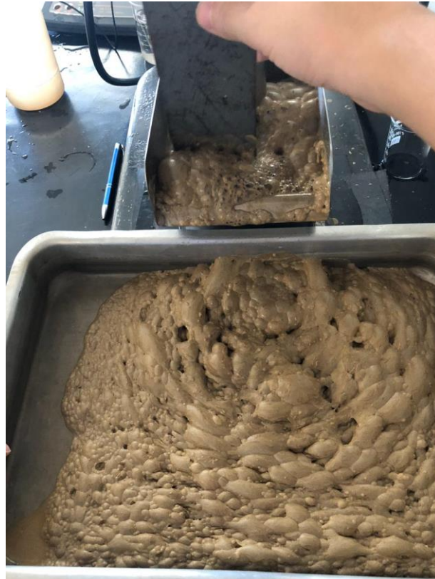
Figura 13 - Processo de retirada da espuma mineralizada.
