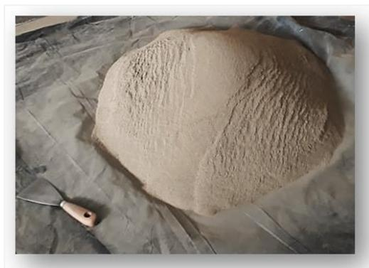
Figura 5 - Amostra da fração grossa pré-homogeneizada em lona
