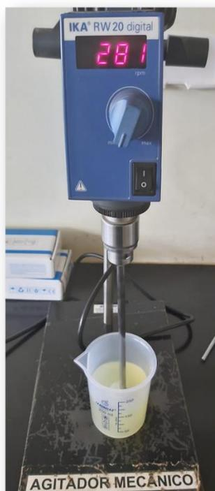
Figura 9 - Solução de depressor em processo de gelatinização
