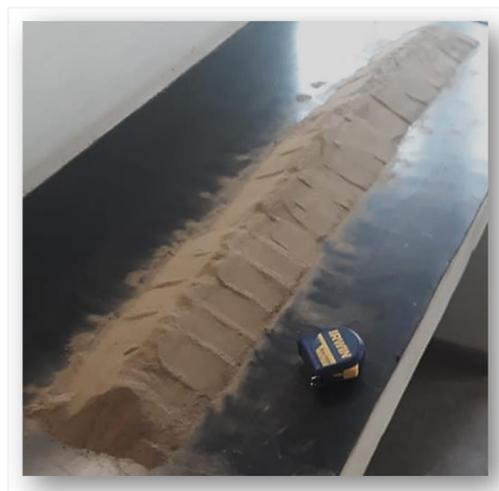
Figura 7 - Pilha alongada da fração fina em bancada para separação de frações.
