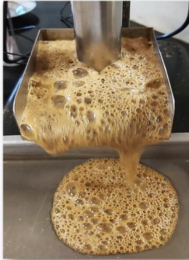
Figura 15 – Coleta de concentrado na flotação de bancada.
