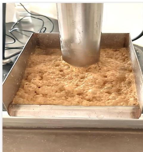
Figura 14 - Formação da espuma de flotação
