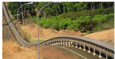
Correia que transporta o minério da mina até à unidade de concentração
