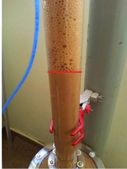
Figura 2: Interface polpa-espuma (Fonte: ALVES et al. , 2016).
