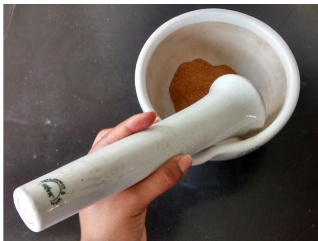
Figura 13: Fragmentação da Apatita no gral de porcelana.
