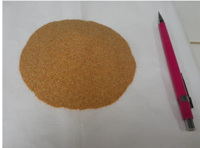
Figura 14: Homogeneização da apatita.
