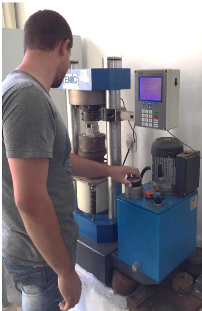
**Figura 12 - Prensagem dos corpos de prova (Autoria própria).**
