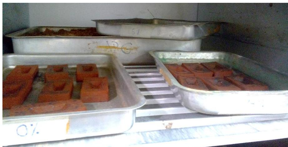
**Figura 14 - Corpos de prova em estufa a 65°C por 60h (Autoria própria).**
