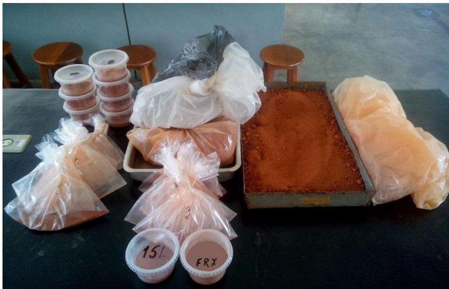
**Figura 11 - Massas das matérias primas devidamente separadas para início da fabricação dos corpos de prova (Autoria própria).**
