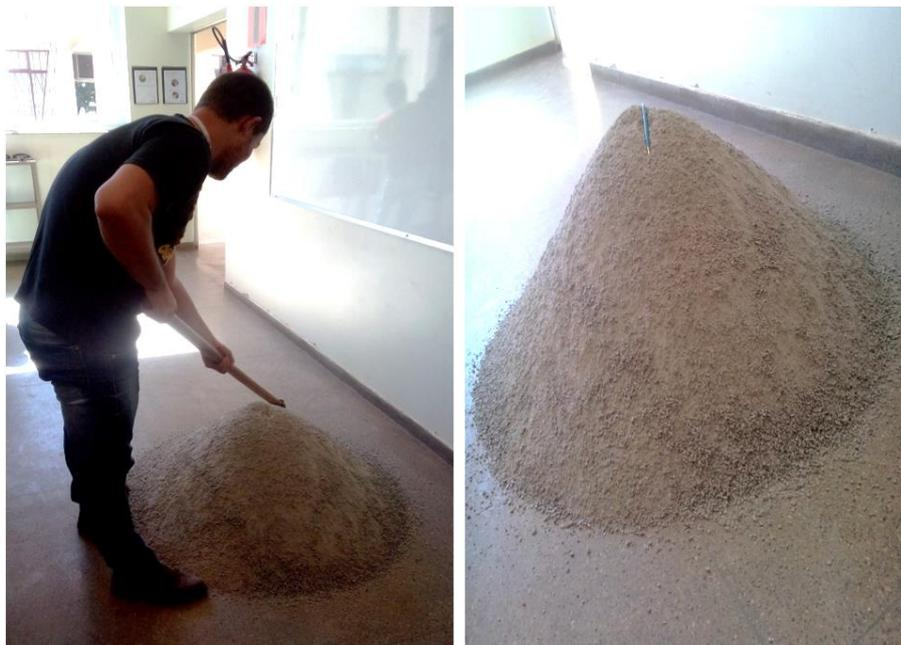
**Figura 6 - Homogeneização em pilha cônica com auxílio da enxada (Autoria própria).**
