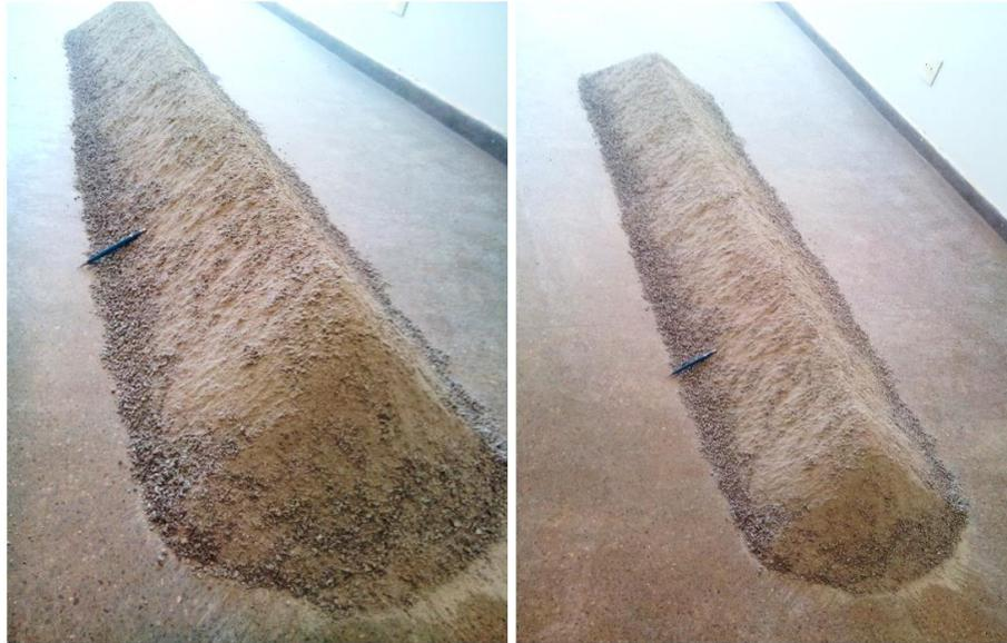
Figura 7 - Homogeneização em pilha longitudinal (Autoria própria).
