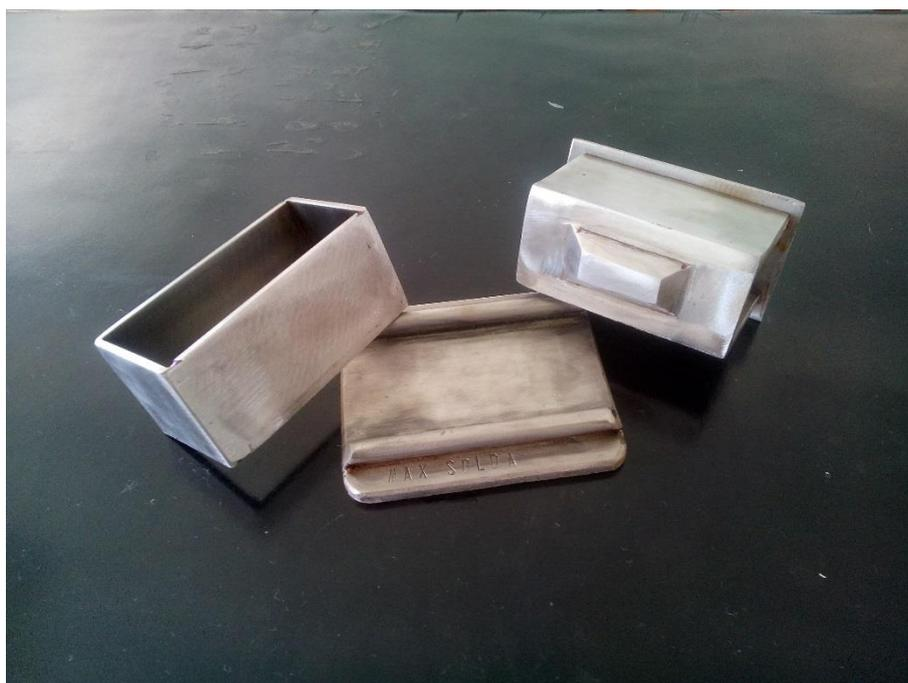
**Figura 9 - Molde em aço inox utilizado para confecção dos corpos de prova (Autoria própria).**
