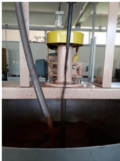
Figura 20: Descarga do apex com minério de ferro.
