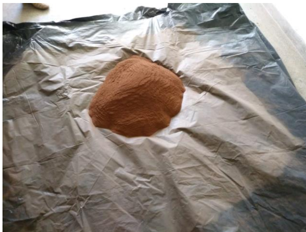
Figura 8: Pilha cônica para pré-homogeneização.
