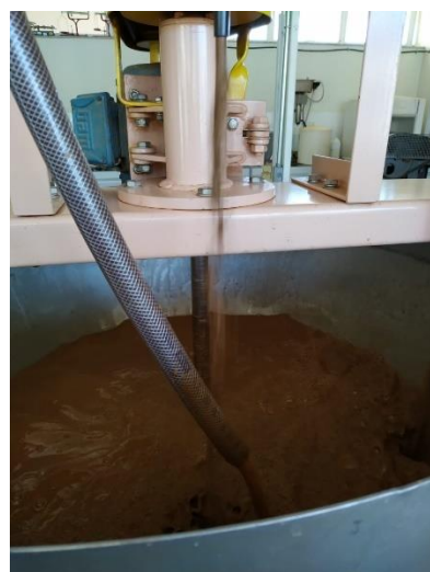
Figura 21: Descarga do apex com minério fosfático.
