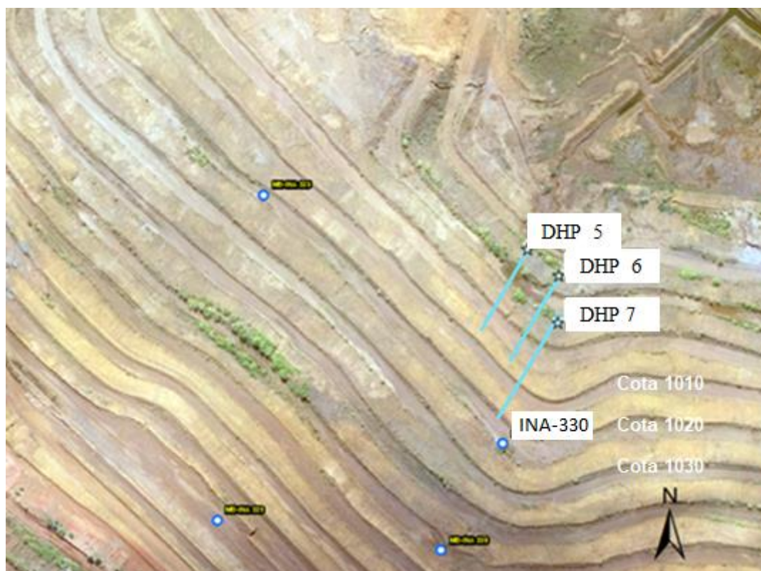
Figura 15: DHP's em operação - frente 1 Fonte: Relatório interno Hidrogeologia 2019
