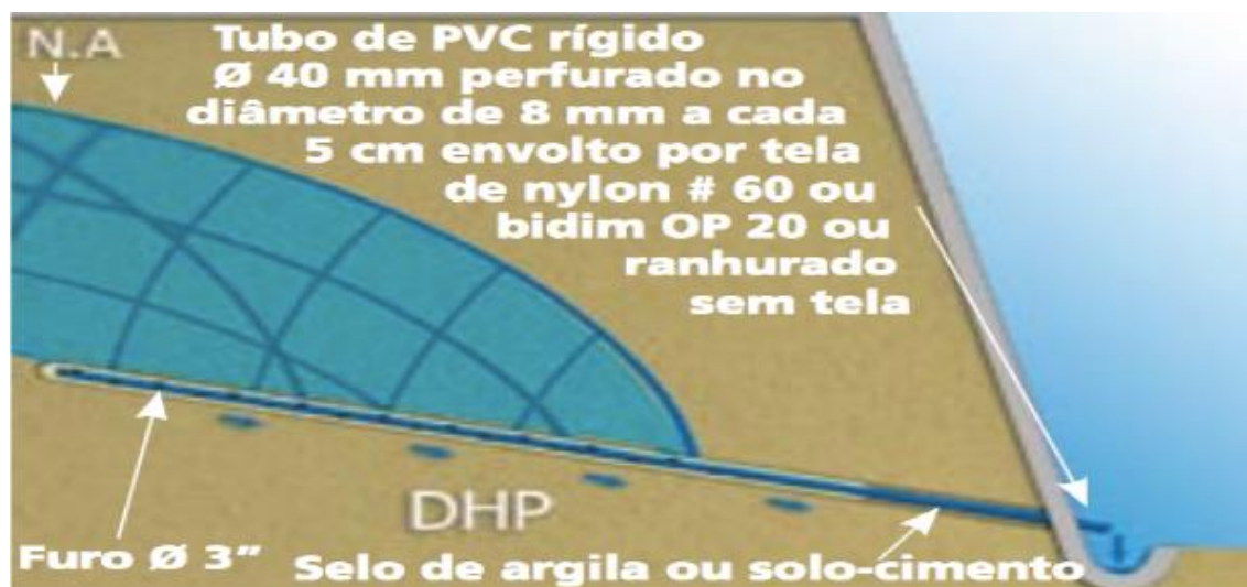
Figura 11: Exemplo de drenagem horizontal profundo
