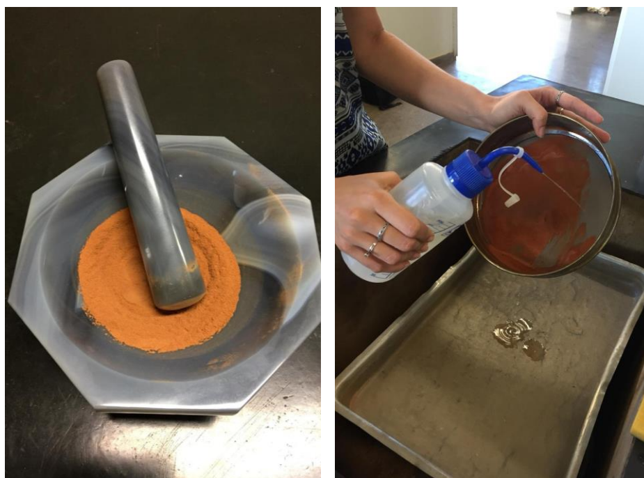
Figura 6: (A) Amostra submetida à pulverização; (B) Retirada de retidos da peneira após pulverização.
