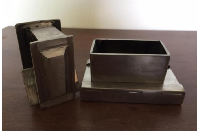
Figura 7: Componentes da fôrma utilizada para fabricação dos tijolos.
