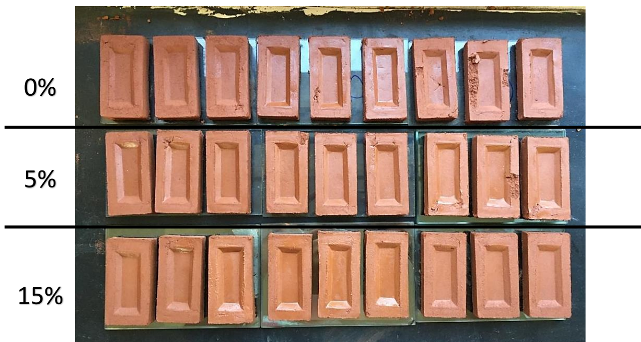
Figura 17: Tijolos fabricados com 0%, 5% e 15% de substituição, respectivamente (de cima para baixo).
