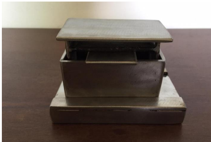
Figura 8: Fôrma montada utilizada na fabricação dos tijolos.
