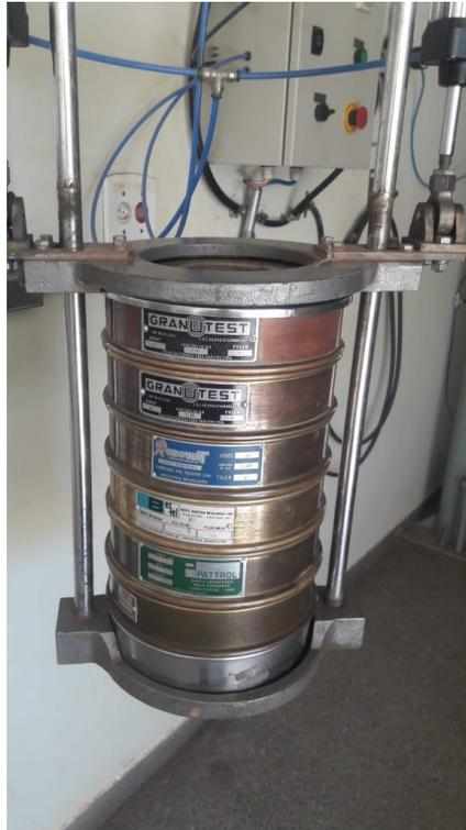
Figura 19: Peneirador suspenso.
