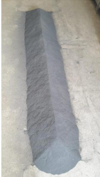
Figura 15: Pilha alongada, amostra inicial.
