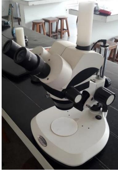
Figura 20: Lupa trinocular utilizada para determinação do grau de liberação.
