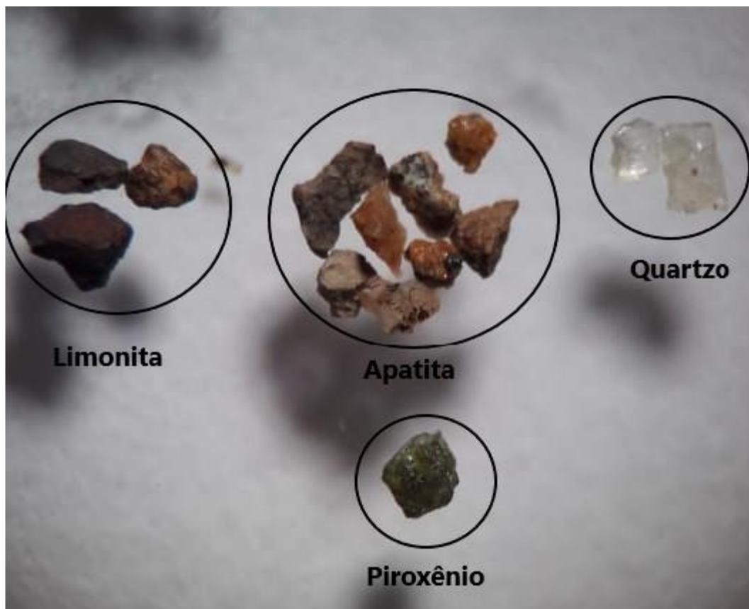
Figura 27: Imagem de lupa trinocular óptico dos minerais piroxênio, limonita, apatita e quartzo.
