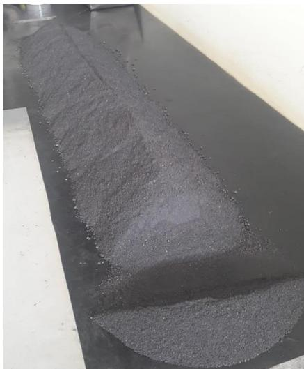
Figura 16: Pilha alongada para separação de alíquotas de 0,500kg.
