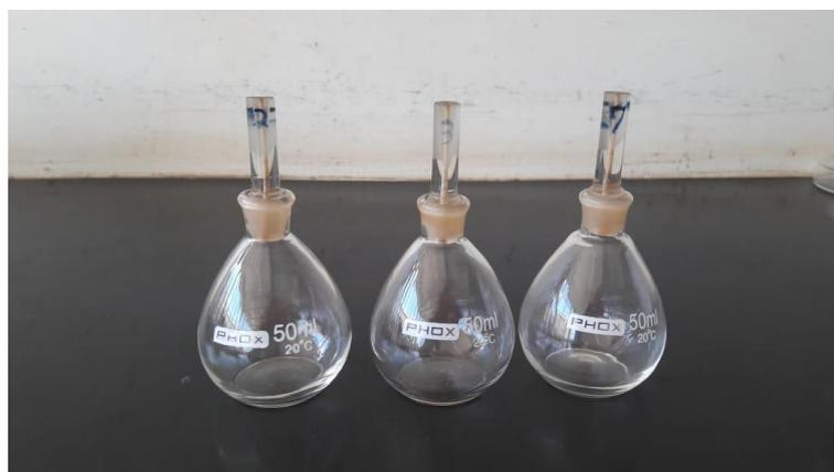
Figura 10: Vidraria utilizada para testes de picnometria.
