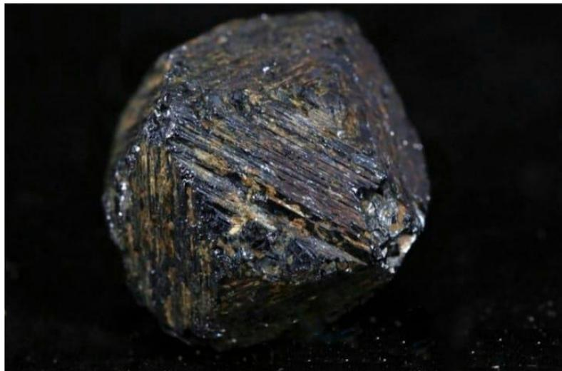
Figura 5: Mineral de Magnetita.
