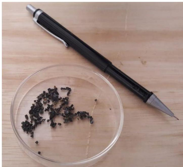
Figura 21: Partículas de 1200  $\mu\text{m}$  dispostas em uma placa de Petri.
