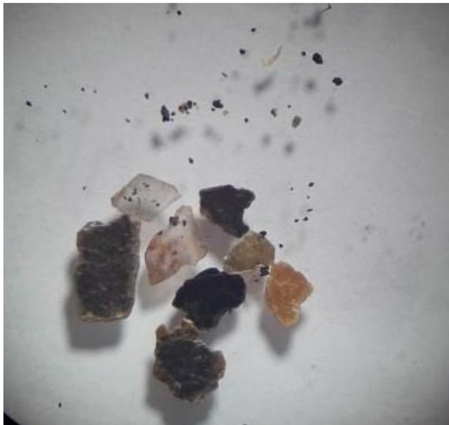
Figura 26: Imagem de lupa trinocular dos minerais flogopita, vermiculita e quartzo.
