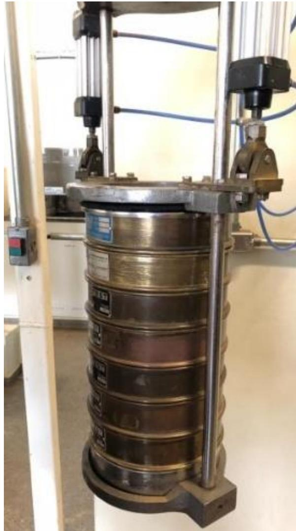
Figura 11: Série de peneiras acopladas ao peneirador suspenso.
