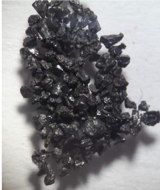
Figura 25: Imagem de lupa trinocular de partícula liberada de magnetita.
