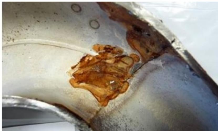
Figura 2.11. Corrosão por frestas em um sistema de tubulação de aço inox 304L – causa: soldagem sem penetração completa (USP, 2019 –C).
