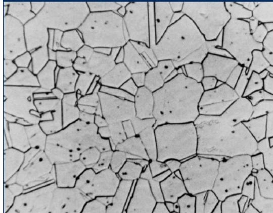
Figura 2.20. Microestrutura típica ferrítica, ataque água-régia 50 x, USP (2019-C).
