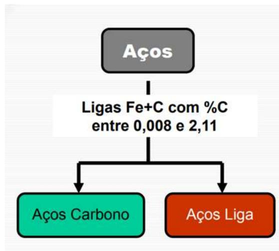
Figura 2.18. Representação esquemática do aço (PAVANATI, 2008).
