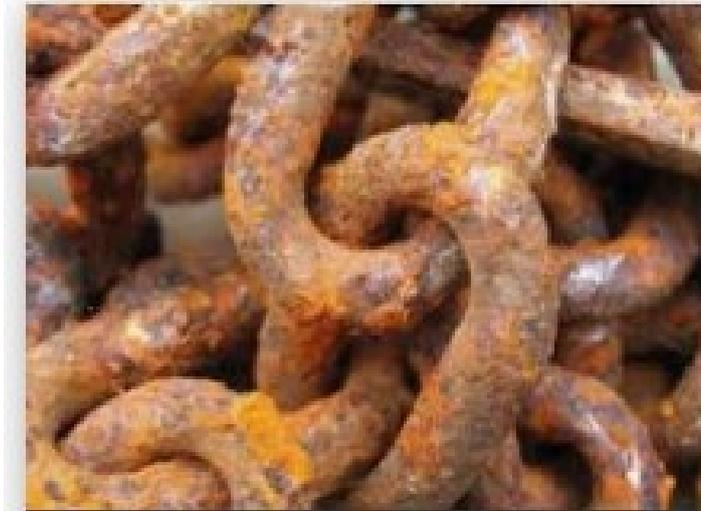
Figura 2.9. Ataque uniforme em uma corrente de aço (USP, 2019 - A).
