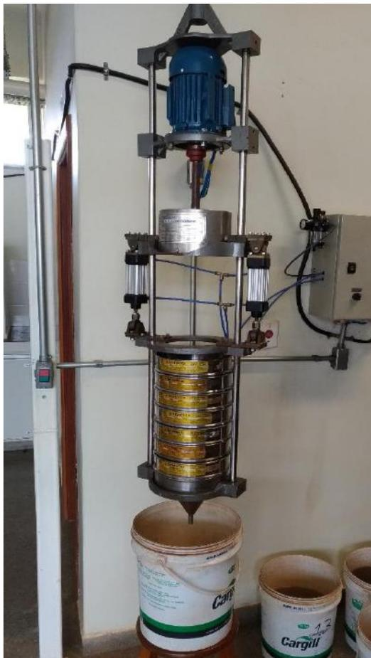
**Figura 13 – Peneirador suspenso.**
