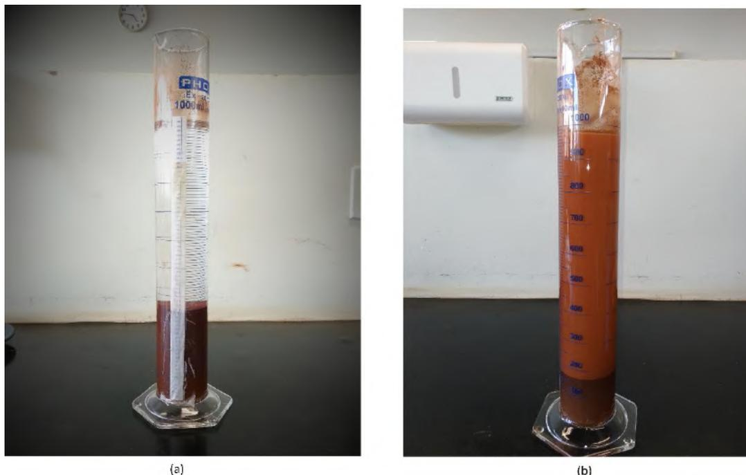
Figura 18- (a) Clarificado com pH 5, (b) clarificado com pH 10.
