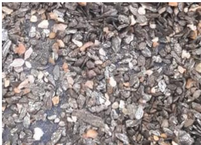
Figura 17 - Amostra aleatória de grãos de minério de ferro retido em 20#.
