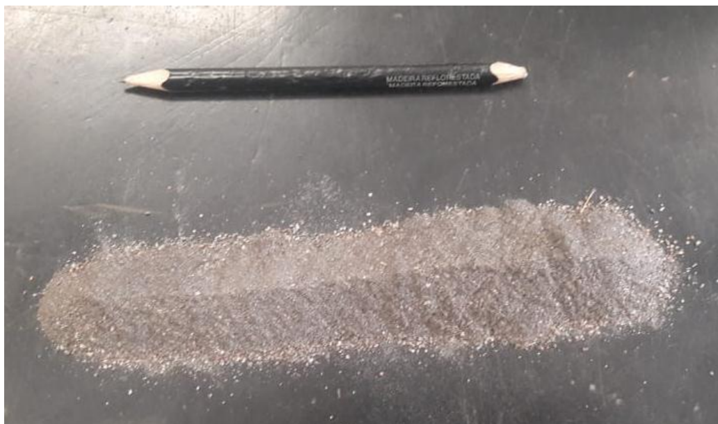
Figura 6 - Pilha alongada de homogeneização de amostra da PPC.
