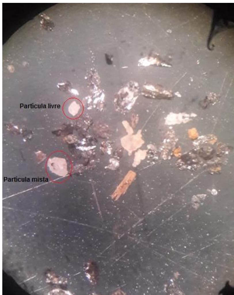
Figura 14 - Partículas mistas e liberadas da faixa entre 20# e 35# de minério de ferro.
