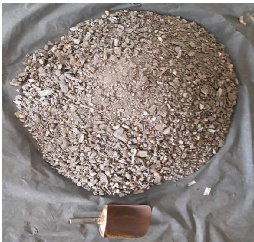
Figura 5 - Pilha cônica de homogeneização da amostra.
