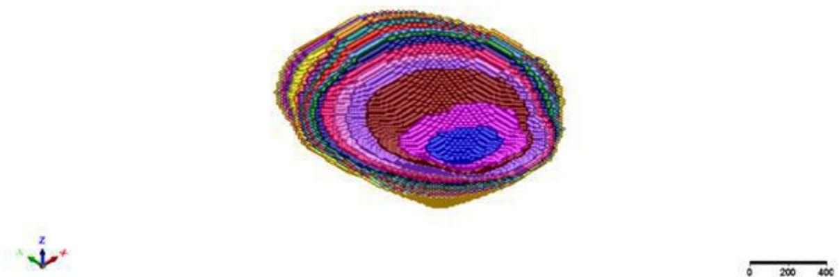
Figura 17 - Cavas aninhadas obtidas pela otimização dos blocos do depósito.
