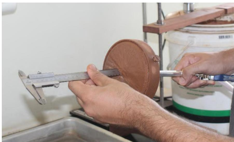
Figura 58 - Aferição da espessura da torta.
