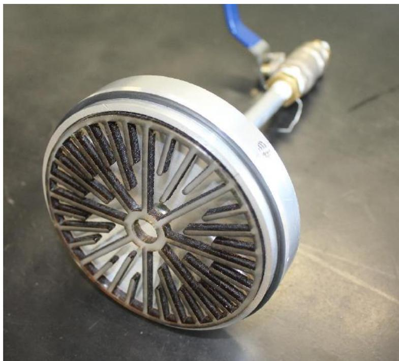
Figura 37 - Filtro com a Tela encaixada.
