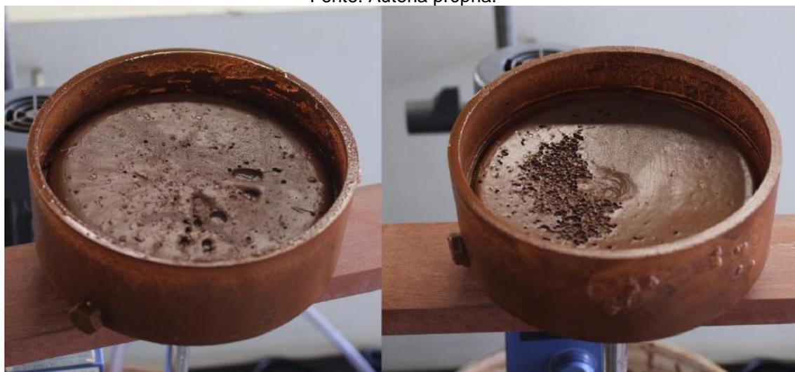
Figura 54 - Comparativo teste 2 (esquerda) e 4 (direita).
