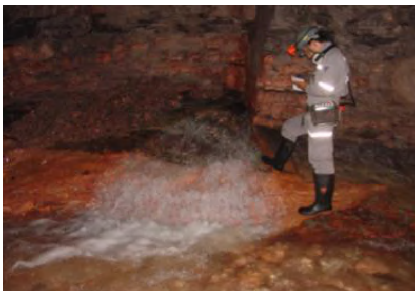
Figura 4 - Surgências ocorridas na Mina subterrânea de Vazante. (Coulto L.C.G e Nascimento G.C.S. em apresentação no “4º Congresso Brasileiro de Túneis e Estruturas Subterrâneas”)
