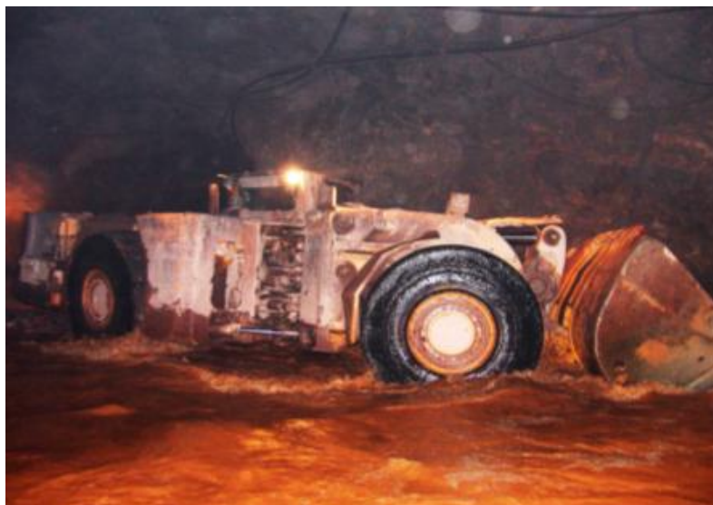
Figura 5 – Fluxo de água na Mina de Vazante. (Coulto L.C.G e Nascimento G.C.S. em apresentação no “4º Congresso Brasileiro de Túneis e Estruturas Subterrâneas
