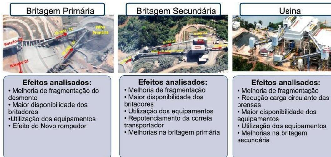
Figura 3 – Efeitos analisados referentes às operações de britagem primária, britagem secundária e operações na usina.
