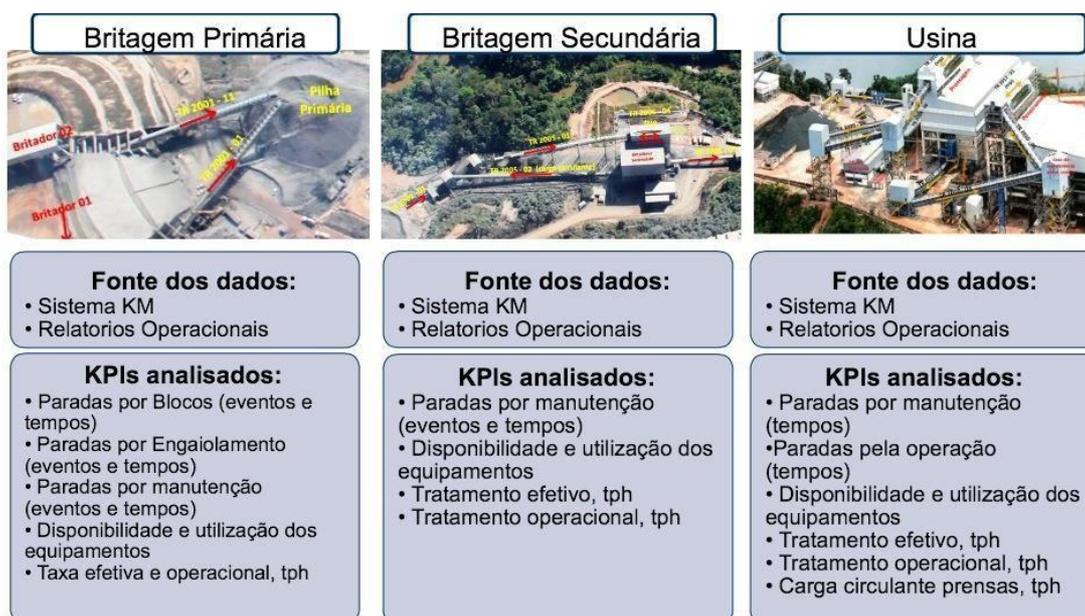
Figura 2 - Fonte de dados e KPI's analisados referentes às operações de britagem primária, britagem secundária e operações na usina.
