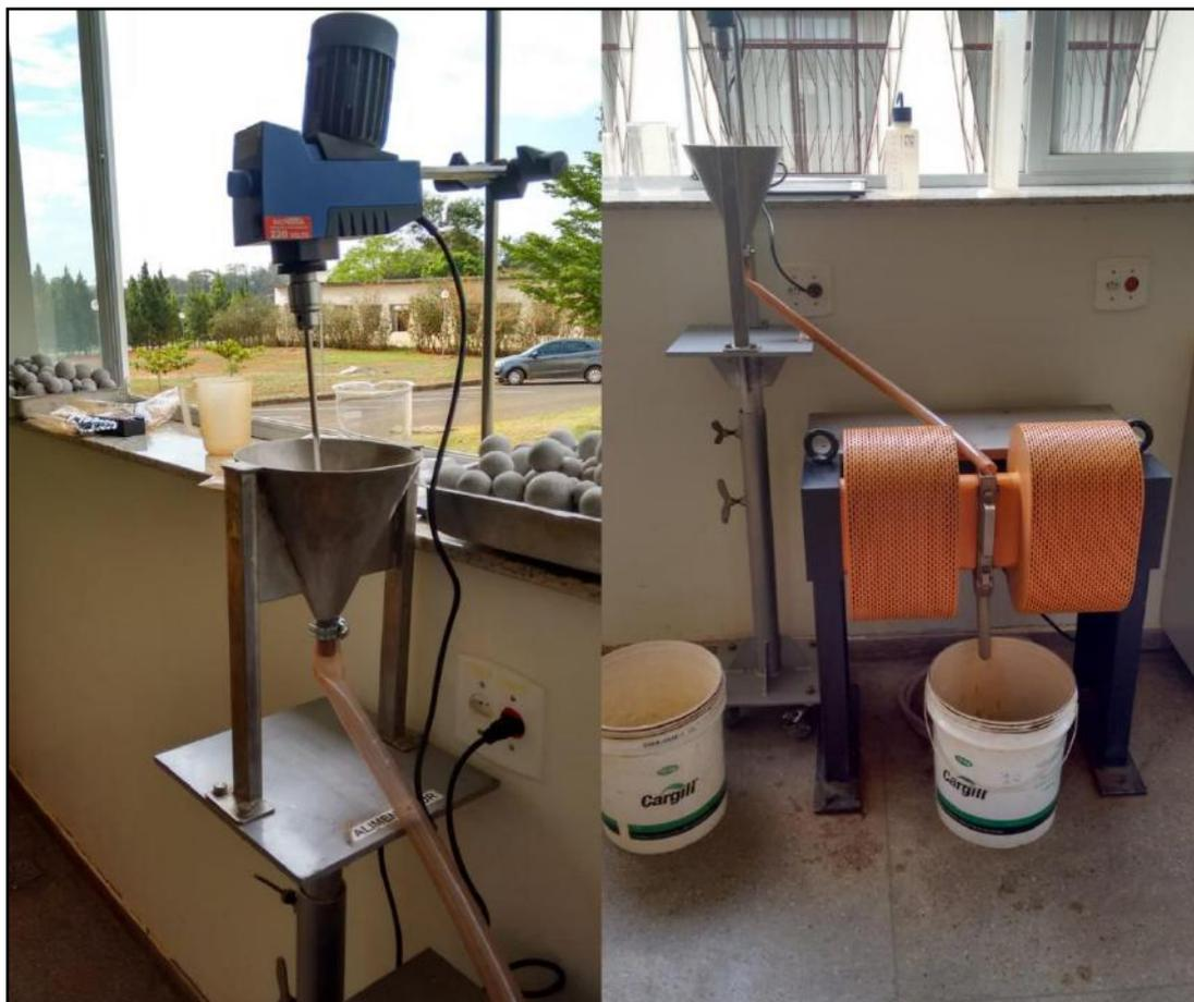
Figura 16 - Separador Magnético de escala laboratorial e alimentador.
