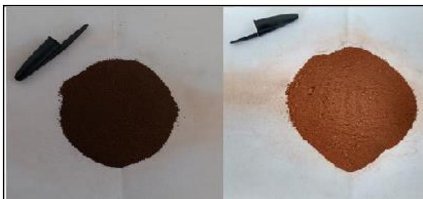
Figura 18- Concentrado (esquerda) e rejeito (direita) provenientes da etapa *scavenger*.
