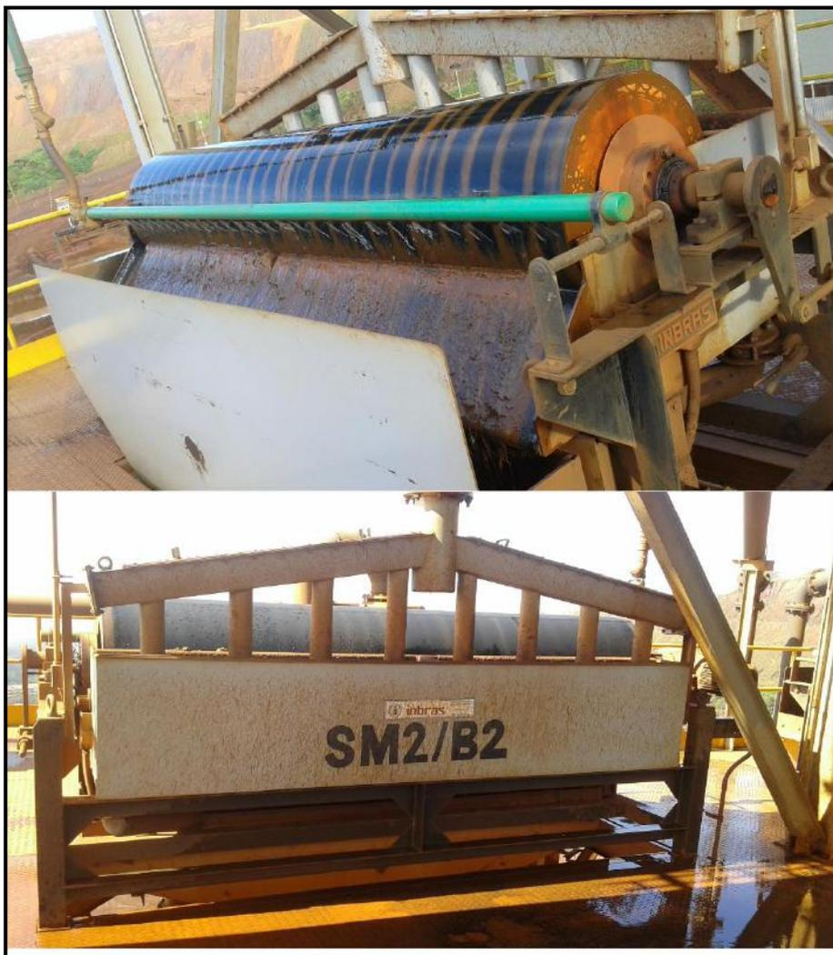
Figura 10 - Separador magnético de tambor da Mineral do Brasil LTDA. com vista frontal e lateral.
