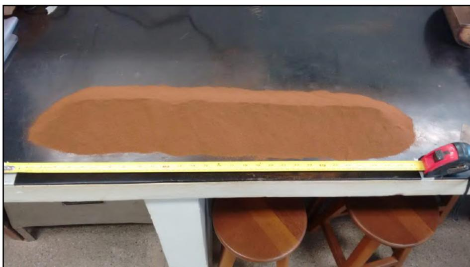
Figura 14 - Pilha alongada do material passante em 0,425 mm.
