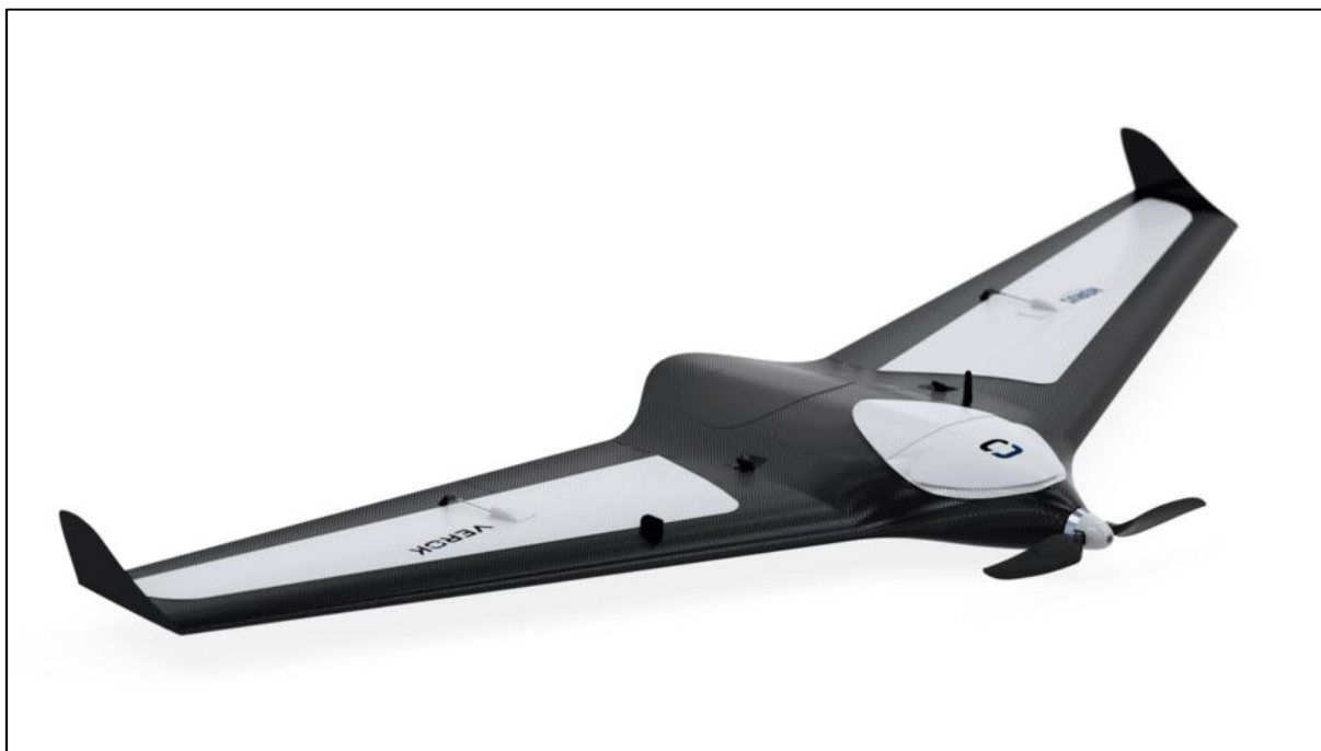
Figura 1: Exemplo de Drone do tipo Asa Fixa. Modelo Verok da Horus com 3,1 Kg, envergadura de 1,7 m e tempo de voo de até 120 min. Fonte: reprodução site Horus Aeronaves, 2018.
