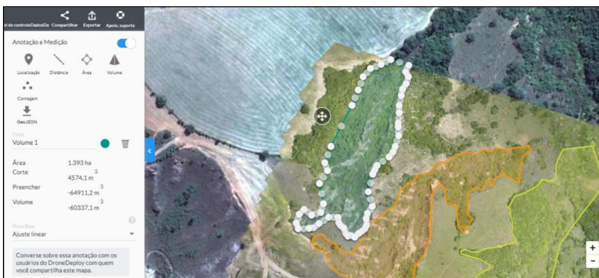
Figura 19: Detalhe da marcação das grotas para cálculo do volume. Fonte: do autor
