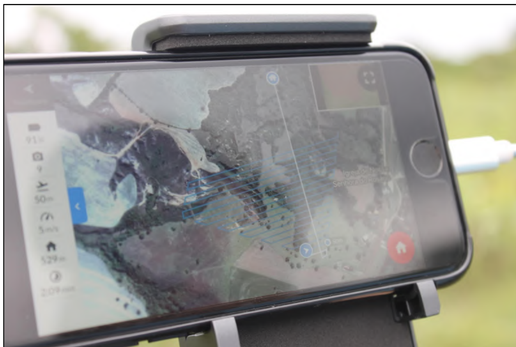
Figura 17: Tela do aplicativo DroneDeploy. Detalhe do plano de voo e traçado. Na parte superior da tela é possível ver a imagem da câmera do drone em tempo real. Fonte: do autor
