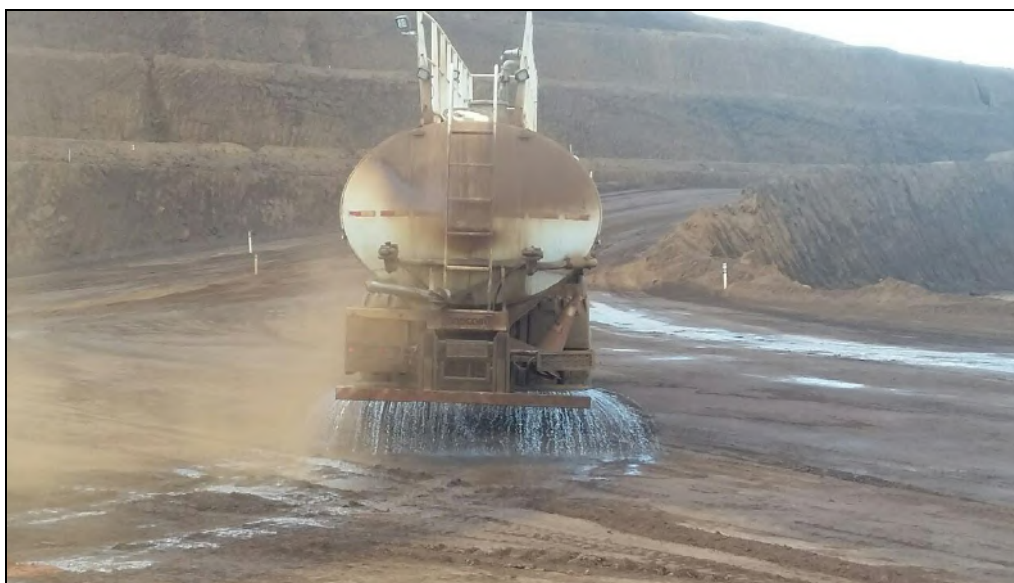
Figura 2-8 - Aspersão das vias por queda livre. Fonte: Autoria própria
