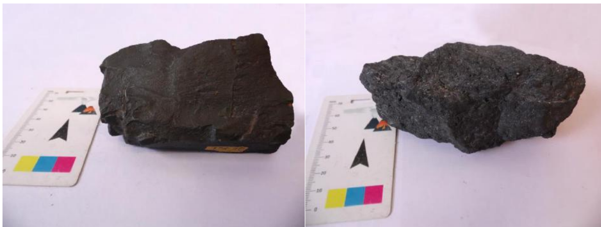
Figura 2.1: Minério hematítico. Fotos tomadas no Laboratório de Mineralogia e Petrografia do CEFET-MG/Unidade Araxá.
