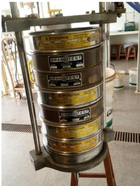
Figura 16: Peneirador suspenso
