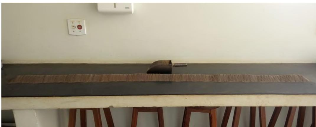
Figura 14: Homogeneização em pilha alongada
