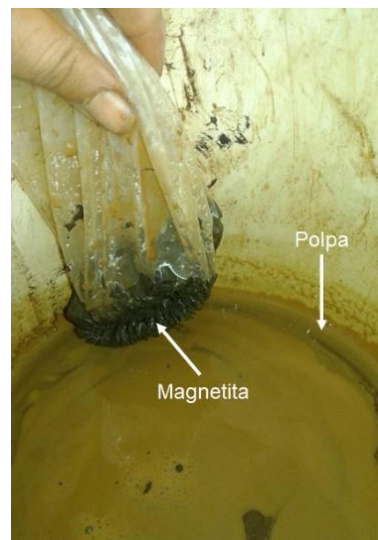
Figura 19 - Separação magnética com imã de mão
