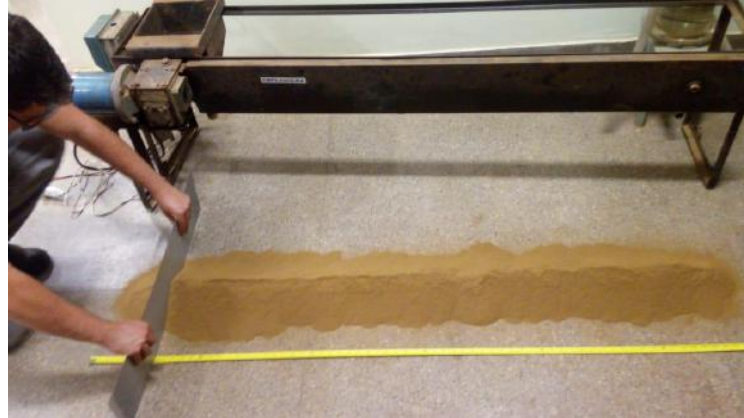
Figura 21 - Quarteamento por pilha alongada
