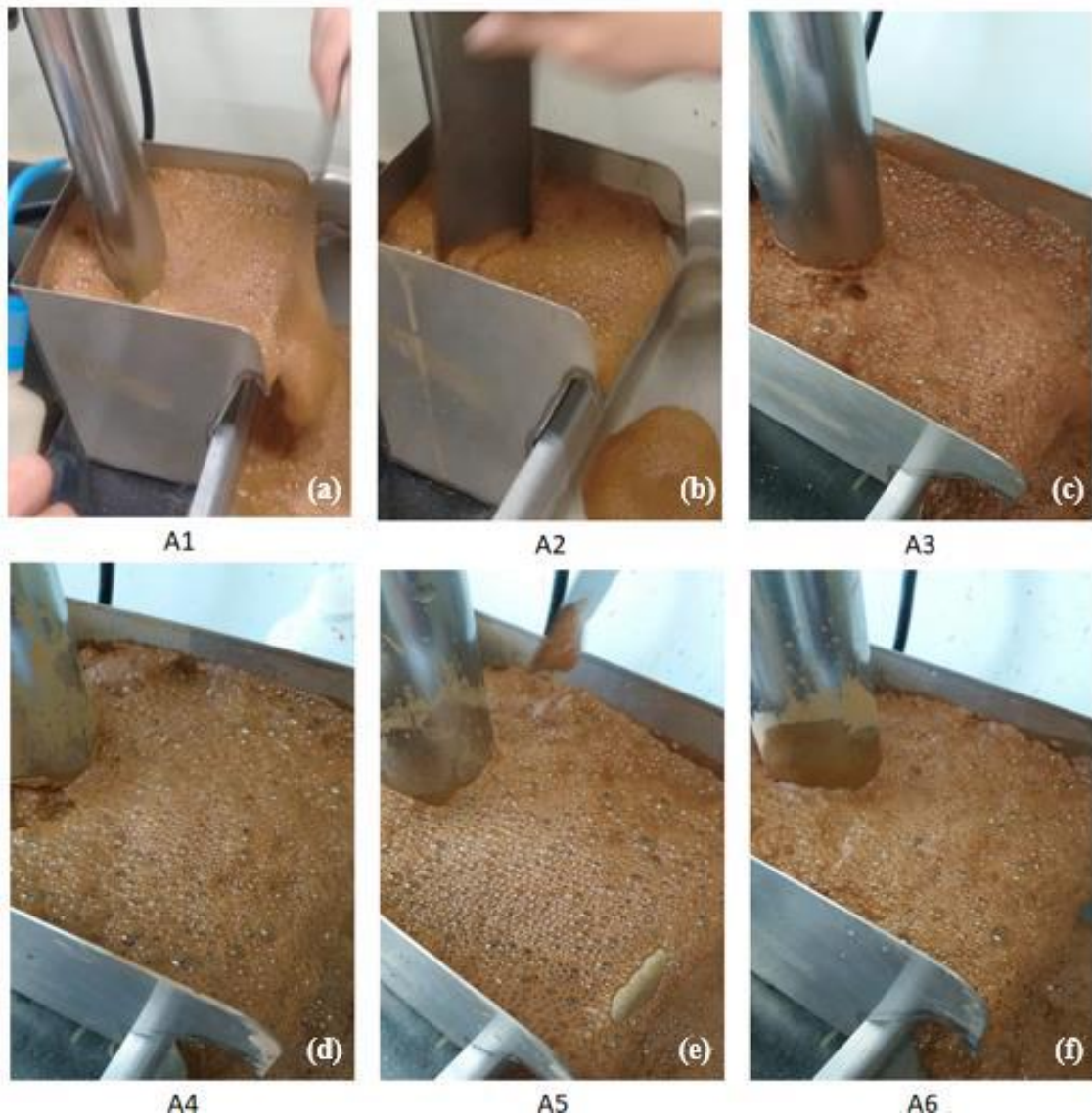
Figura 31 - Aspecto da espuma para cada amido utilizado (a) A1, (b) A2, (c) A3, (d) A4, (e) A5 e (f) A6
