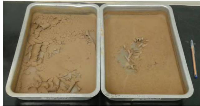
Figura 28 - Rejeito à esquerda e concentrado à direita
