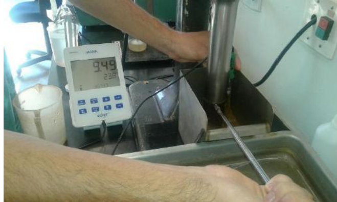
Figura 26 - Condicionamento da polpa
