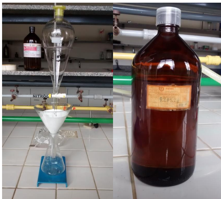
Figura 4.12 - Concentração em meio denso.
