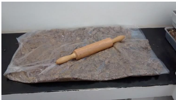
Figura 4.4 - Processo de despelotização.
