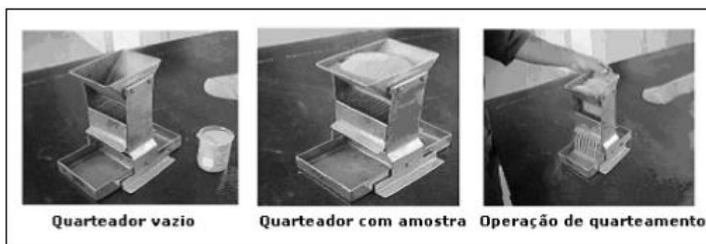
Figura 3.10 - Processo de amostragem no quarteador tipo Jones. (Sampaio et al. 2007, p. 30).
