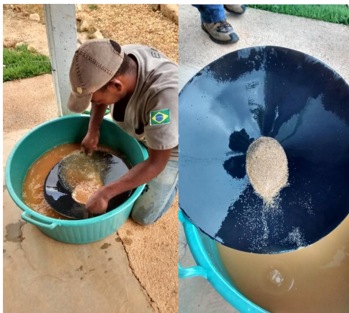
Figura 4.11 - Concentração gravítica com utilização de uma bateia.
