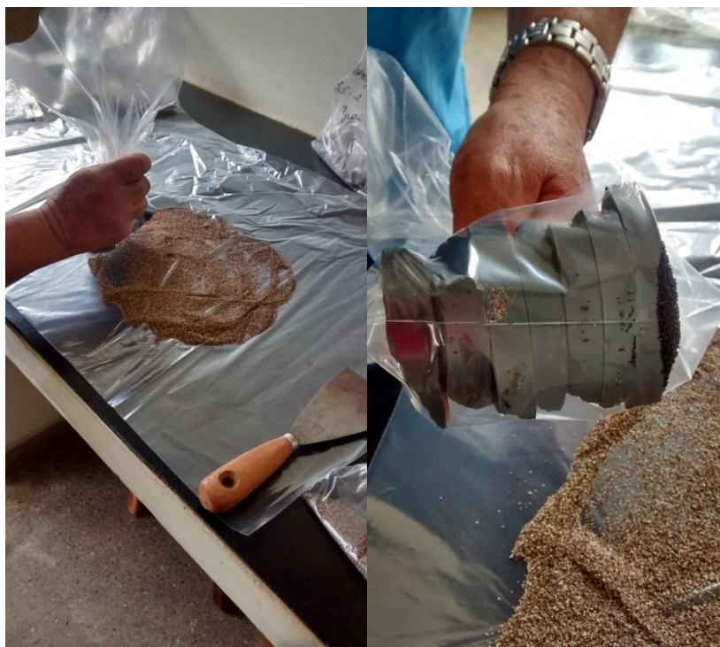
Figura 4.10 - Etapa de separação magnética.
