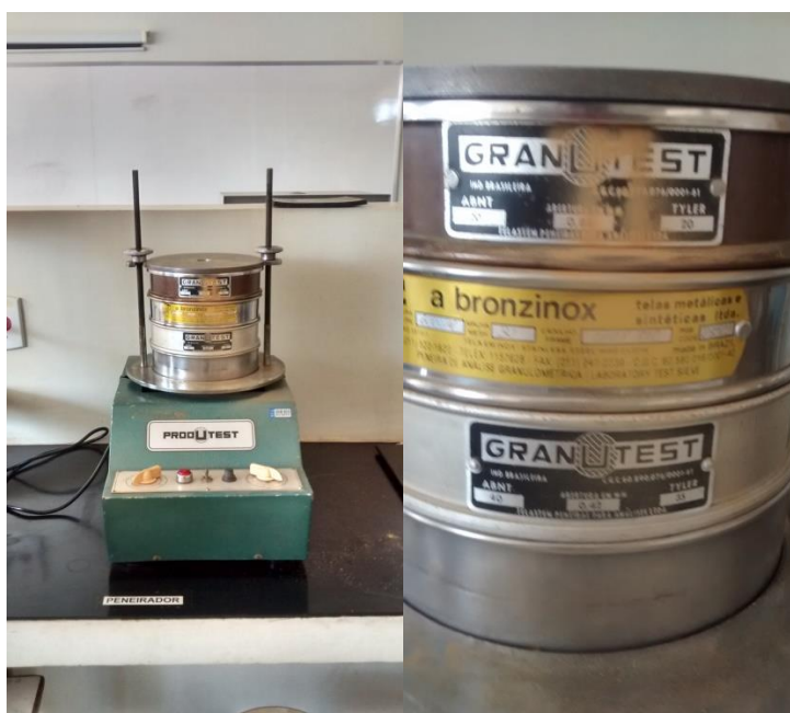
Figura 4.9 - Peneirador e peneiras para separação granulométrica.
