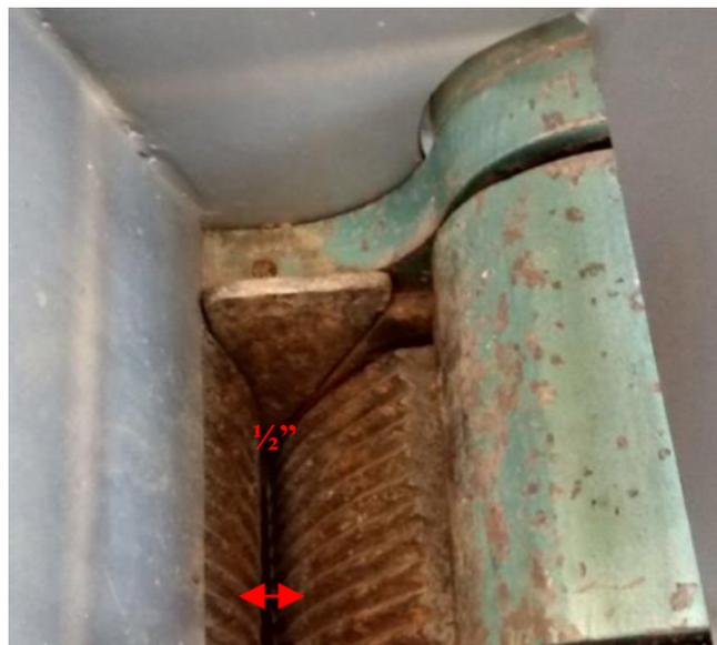
**Figura 3.2** – Abertura na posição aberta (APA) do britador de mandíbulas (seta vermelha representa a abertura).
