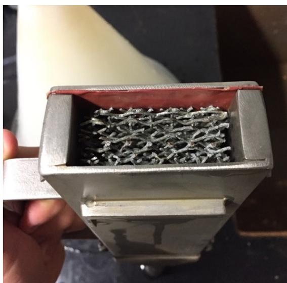
**Figura 3.8** – Matriz utilizada no separador magnético tipo Jones disponível no Laboratório de Tratamento de Minérios na instituição CEFET/MG.
