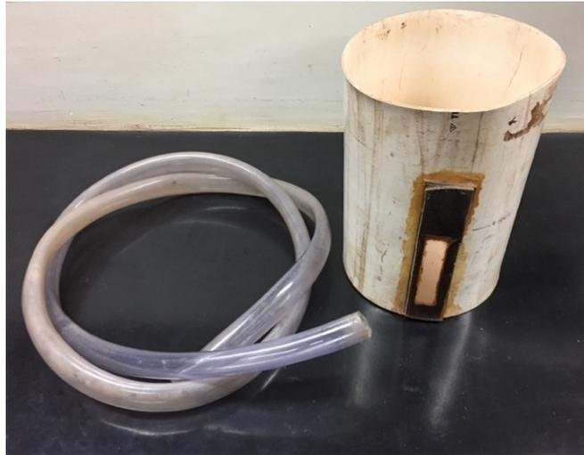
Figura 3.7 – Recipiente de deslamagem e mangueira para realizar o sifão.
