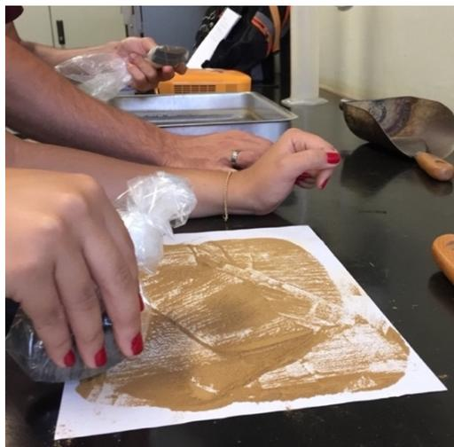
**Figura 3.9** – Separação do material magnético via imã de mão.
