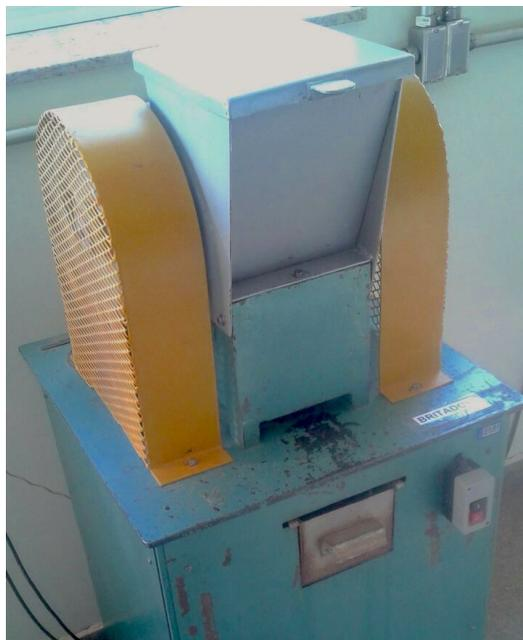
**Figura 3.3** – Britador de Mandíbulas tipo Dodge disponível no Laboratório de Tratamento de Minérios da instituição CEFET/MG.
