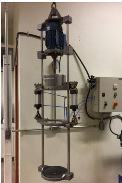
**Figura 3.6** – Peneirador suspenso disponível no Laboratório de Tratamento de Minérios da instituição CEFET/MG.
