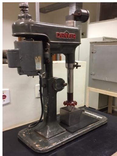
**Figura 3.11** – Célula de Flotação Denver disponível no Laboratório de Tratamento de Minérios da instituição CEFET/MG.
