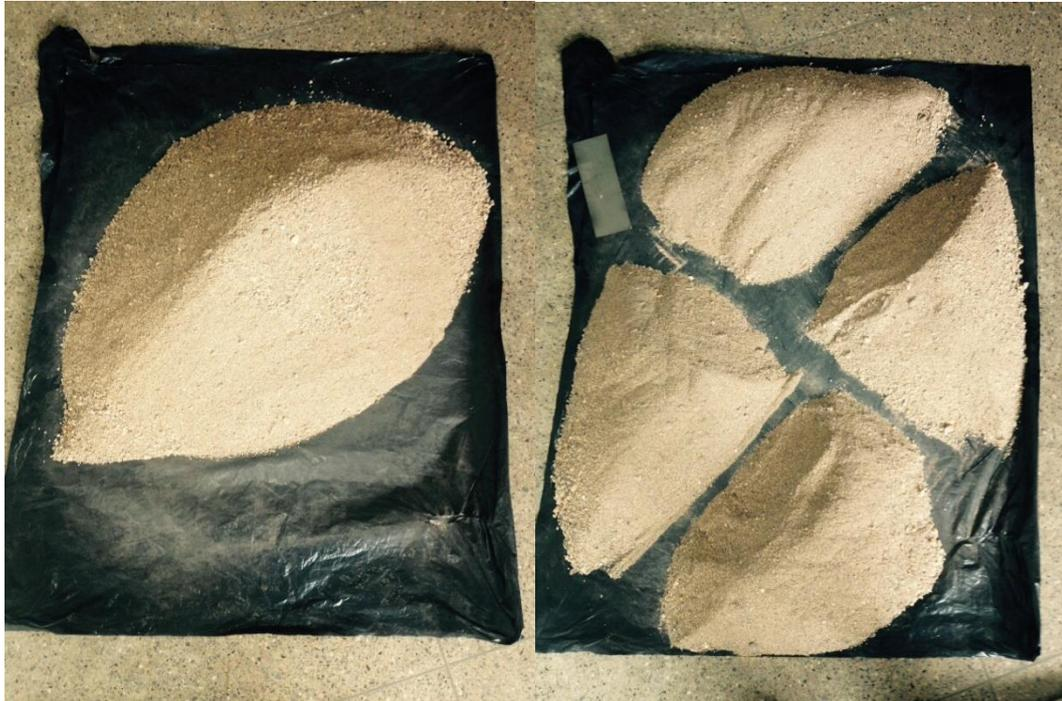
Figura 4.2 – Pilha cônica e pilha cônica dividida em quatro partes.
