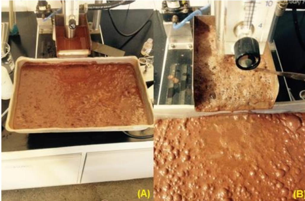
Figura 4.5 – Flotado na bandeja e afuntado na cuba (A) e espuma clara (B).
