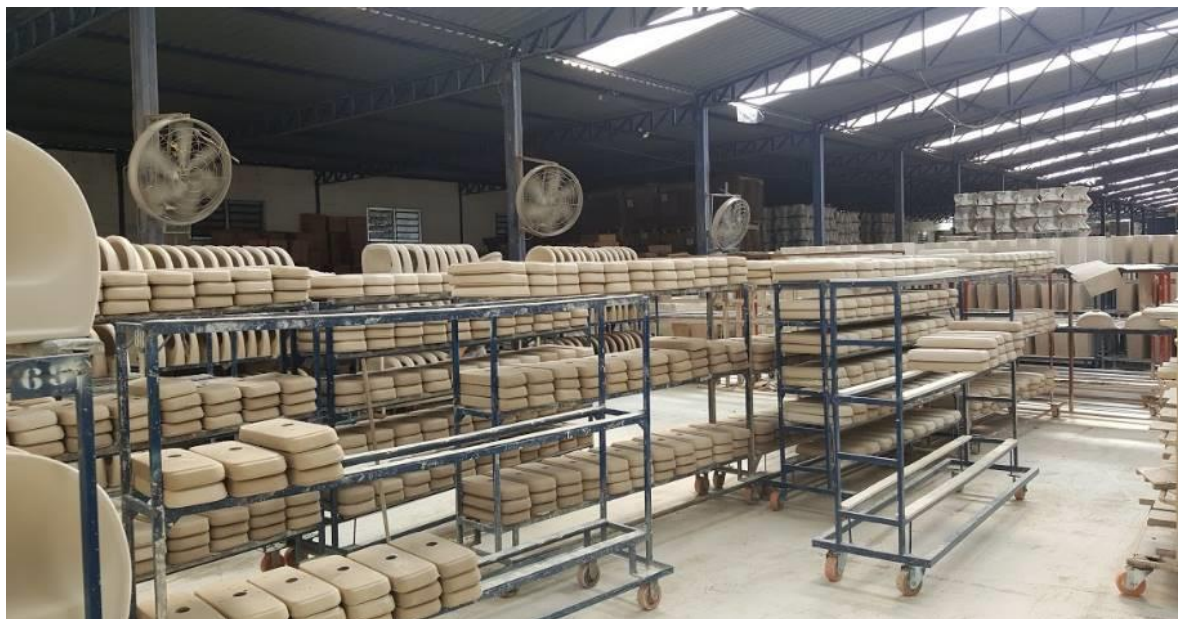
Figura 2.12 – Galpão de secagem lenta das peças
