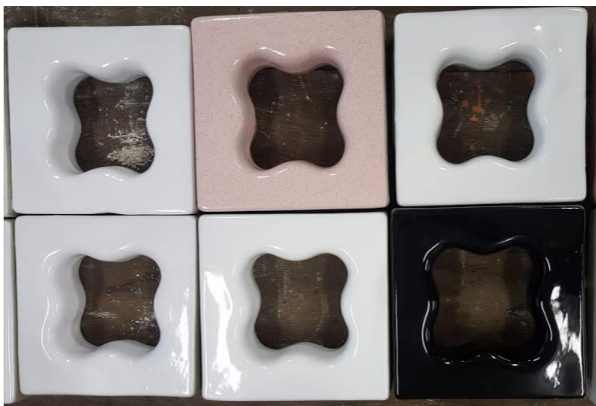
Figura 4.22 – Elementos vazados esmaltados
