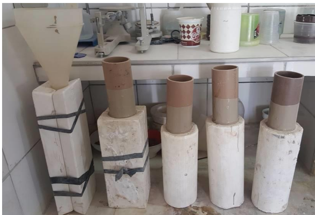
Figura 3.13 – Moldes de gesso com tubos em PVC para auxiliar a conformação de corpos de prova
