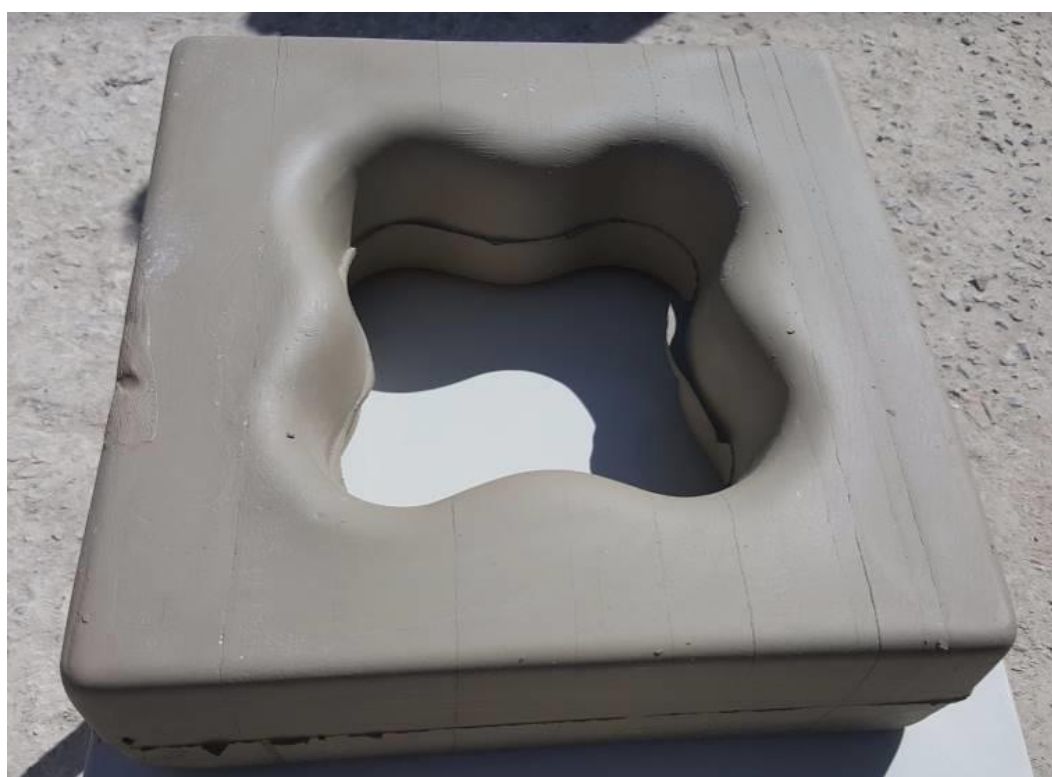
Figura 3.27 – Cobogó destacado da forma após o tempo de fundição
