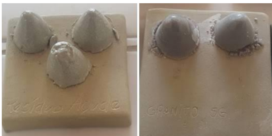
Figura 4.2 – Cones de queima do resíduo da lagoa (à esquerda) e do granito (à direita)
