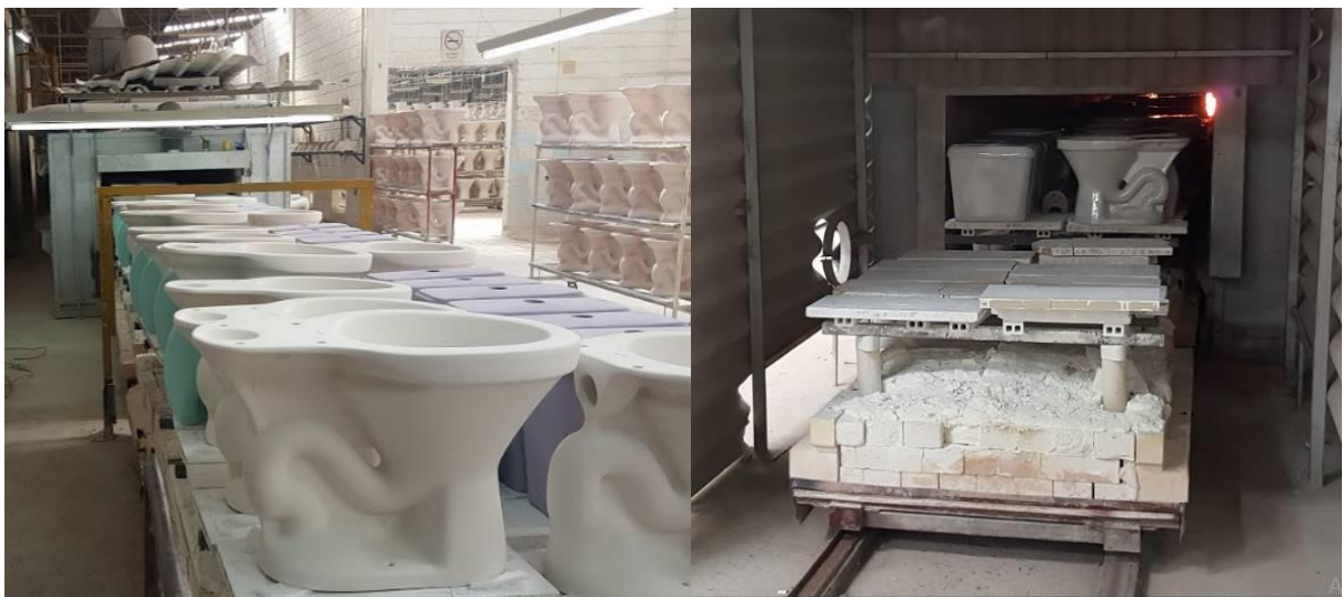
Figura 2.18 – Peças em forno contínuo (entrada do forno à esquerda e saída do forno à direita)
