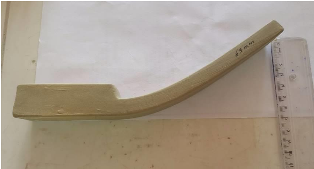
Figura 3.20 – Medição da deformação sofrida pelo corpo de prova
