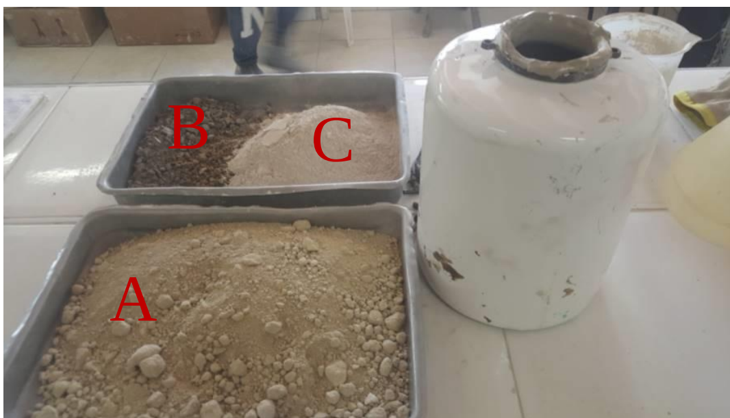
Figura 3.6 – Material utilizado e moinho laboratorial de cerâmica (Em A – Filito, em B – Argilas e em C – Granito e ou resíduo).
