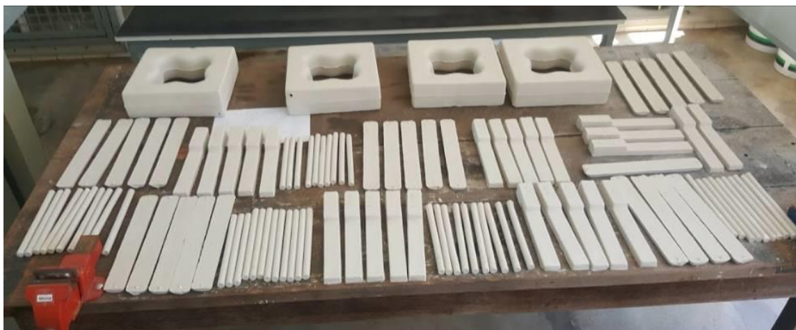
Figura 4.11 – Corpos de prova secos
