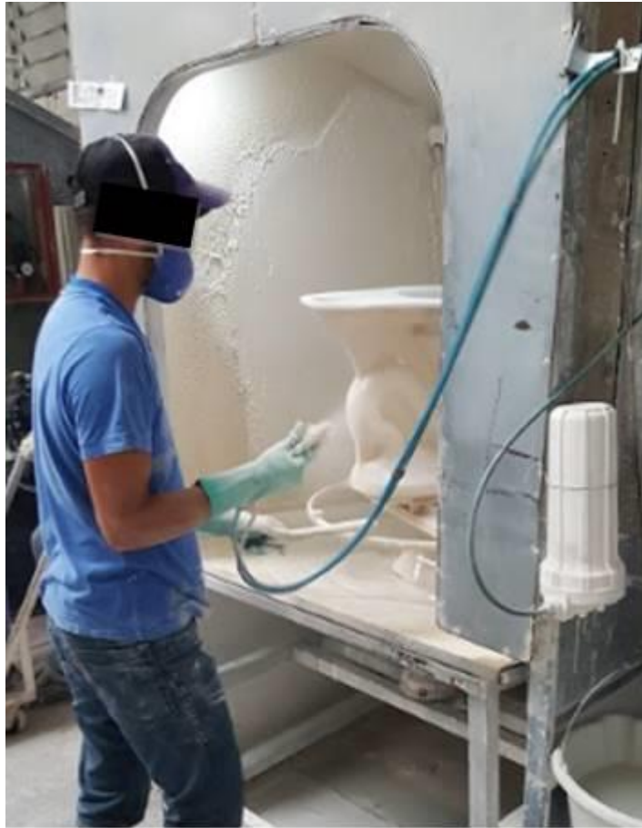
Figura 2.16 – Processo de esmaltação executado por operador
