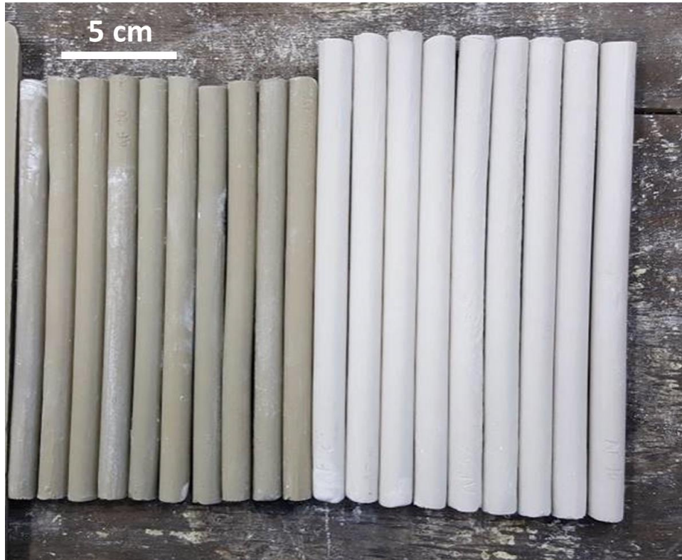
Figura 3.16 – Corpos de prova para determinação de MRF (à esquerda os queimados e à direita os crus, notar a diferença de tamanho).
