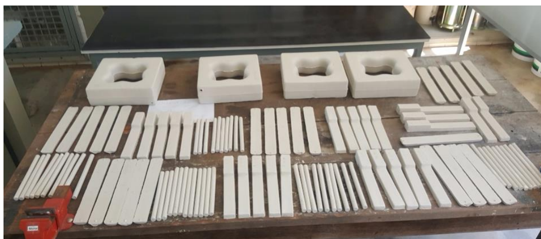
Figura 3.15 – Corpos de prova secos
