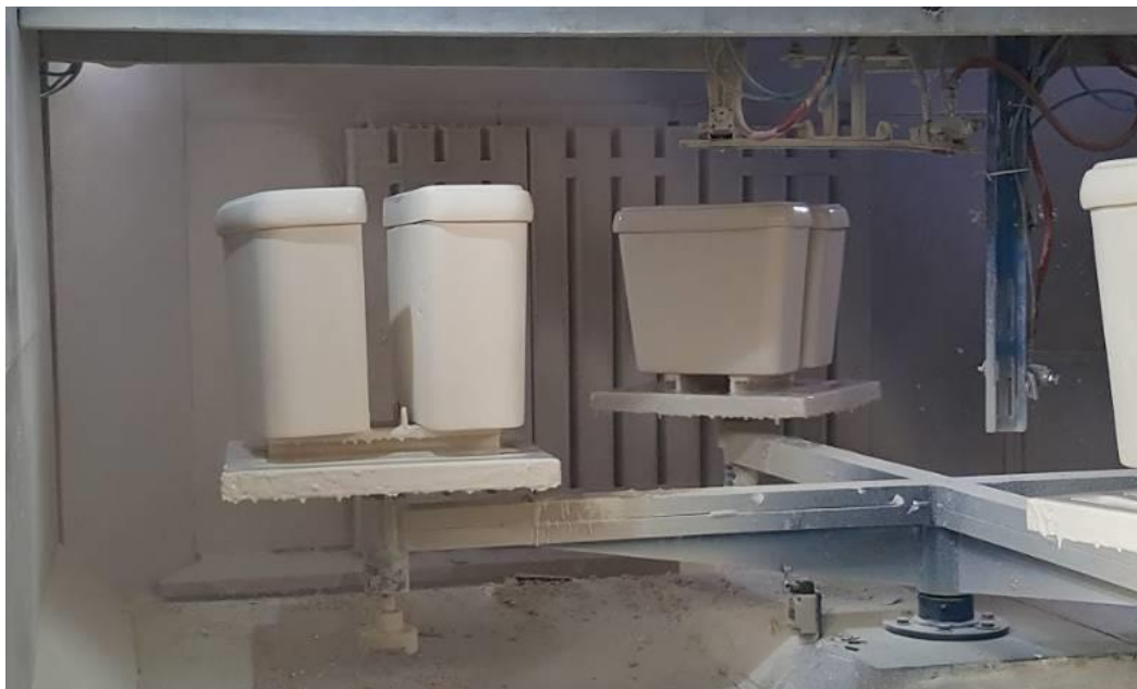
Figura 2.17 - Processo de esmaltação automatizado em carrossel
