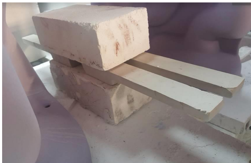
Figura 3.18 – Disposição dos corpos de prova de deformação no forno
