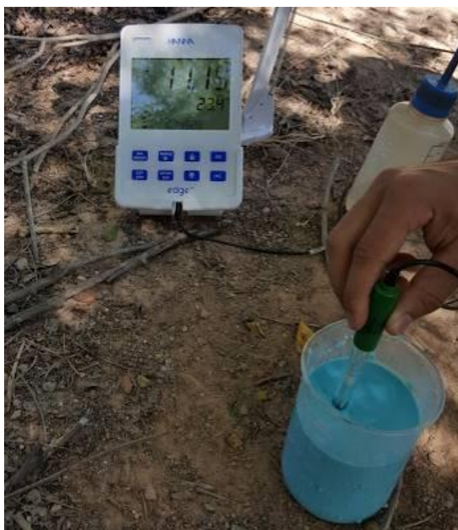
Figura 4.1 – Medição de pH do efluente da esmaltação
