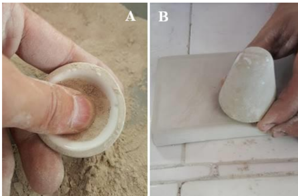
Figura 3.5 – Elaboração dos cones de queima (Em A – Disposição do resíduo no molde, e em B – colocação do cone sobre placa cerâmica).
