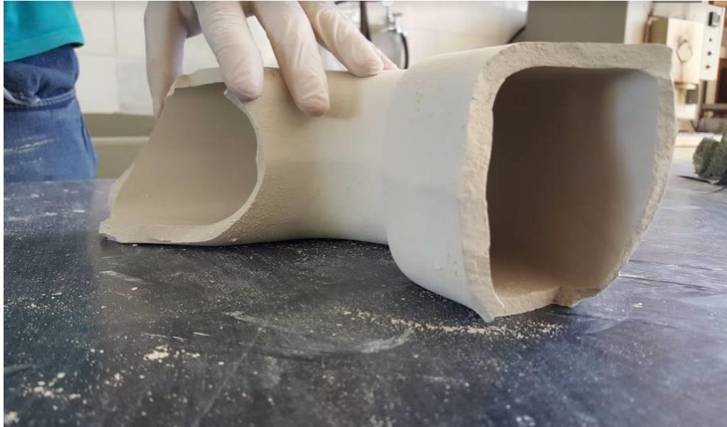
Figura 3.28 – Cobogó cortado para medição de espessura das paredes
