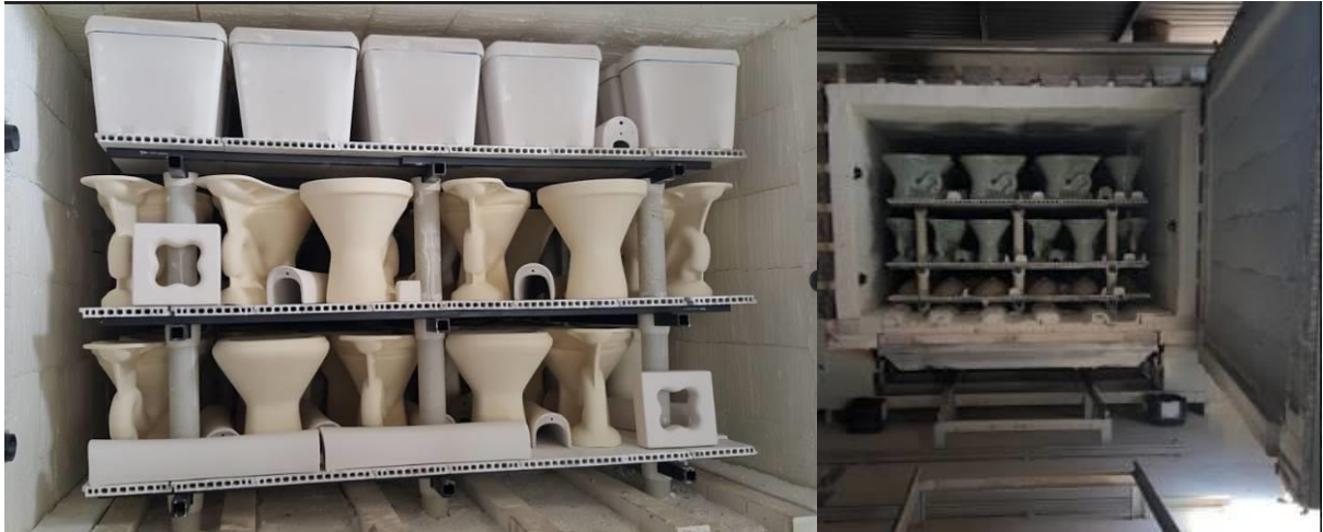
Figura 2.19 - Forno intermitente (antes da queima à esquerda e após a queima à direita)
