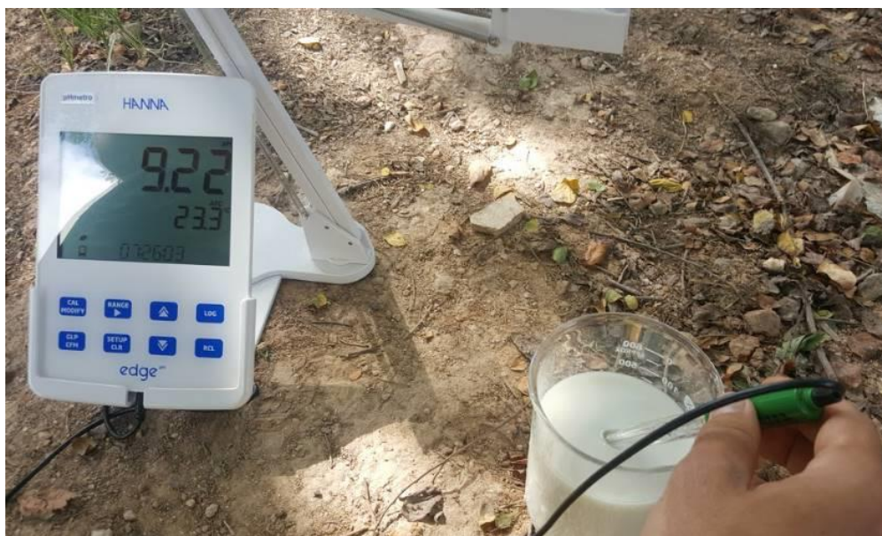
Figura 3.4 – Medição de pH
