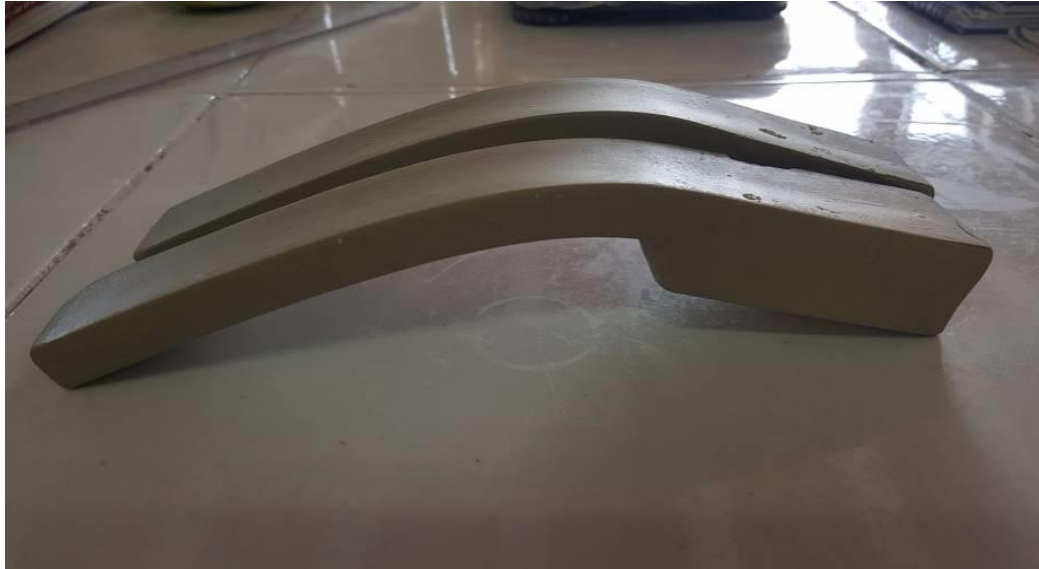
Figura 3.19 – Exemplo de deformação sofrida pelo corpo de prova
