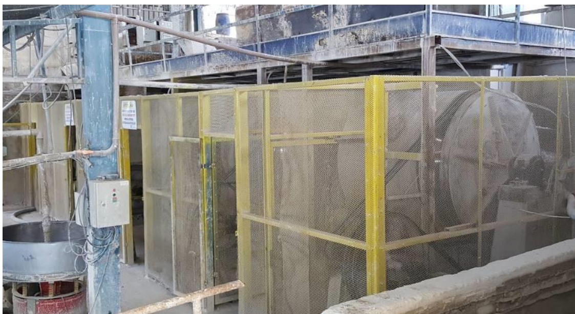
Figura 2.9 – À direita, conjunto de moinhos de seixo em espaço protegido e à esquerda, peneira metálica circular
