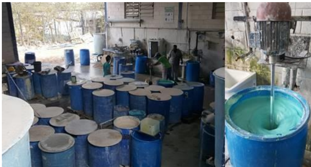
Figura 2.15 – Casa de esmaltes (detalhe de produção de esmalte à direita)
