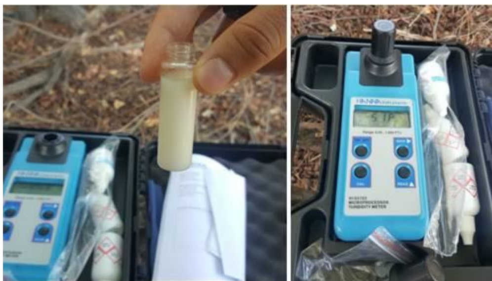
Figura 3.3 – Teste de turbidez
