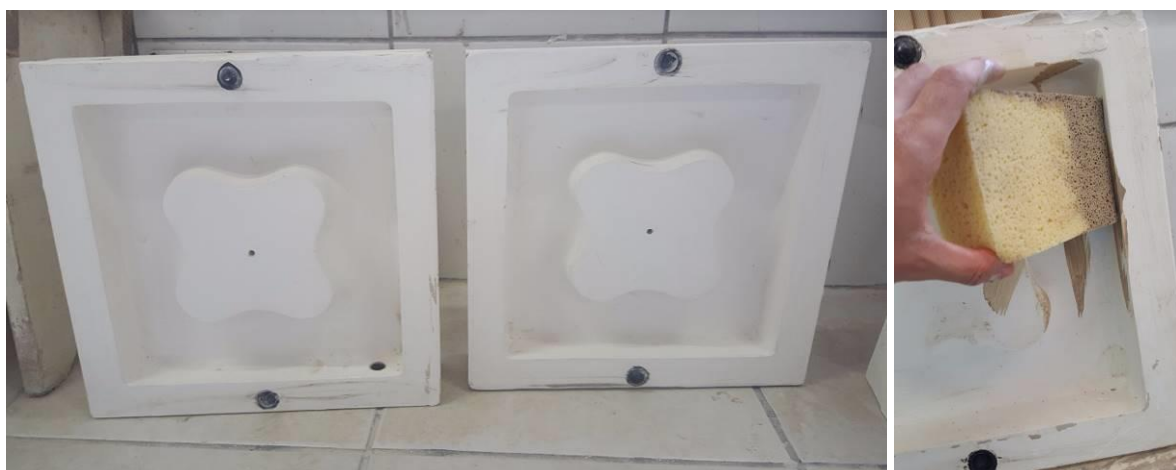
Figura 3.24 – Moldes de gesso e processo de espongeamento de barbotina diluída
