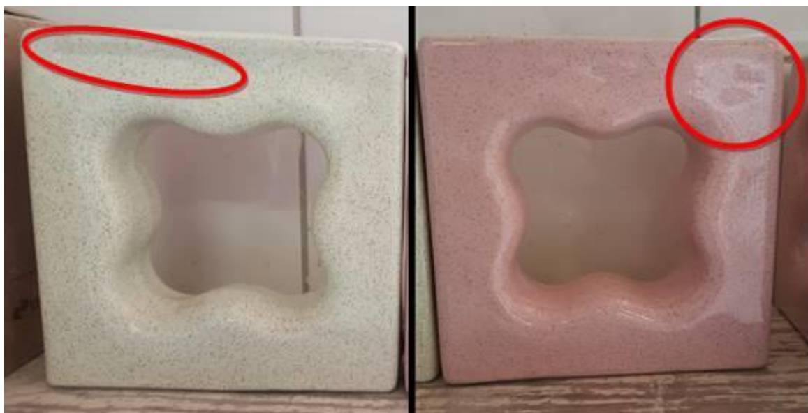
Figura 4.23 – Detalhe nos defeitos estruturais encontrados nos cobogós do grupo AF
