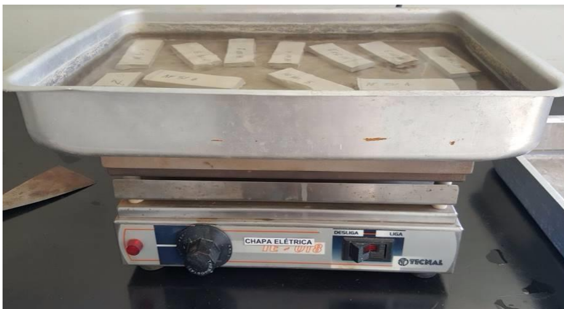
Figura 3.23 – Testes submersos em água aquecida por chapa elétrica
