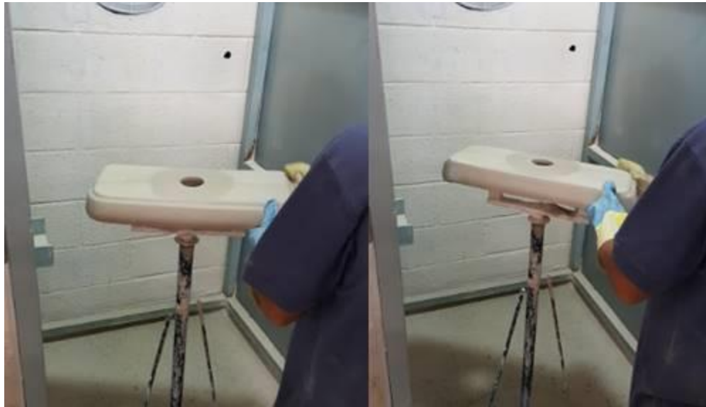
Figura 2.14 – Processo de acabamento executado por técnico em tampa de caixa acoplada
