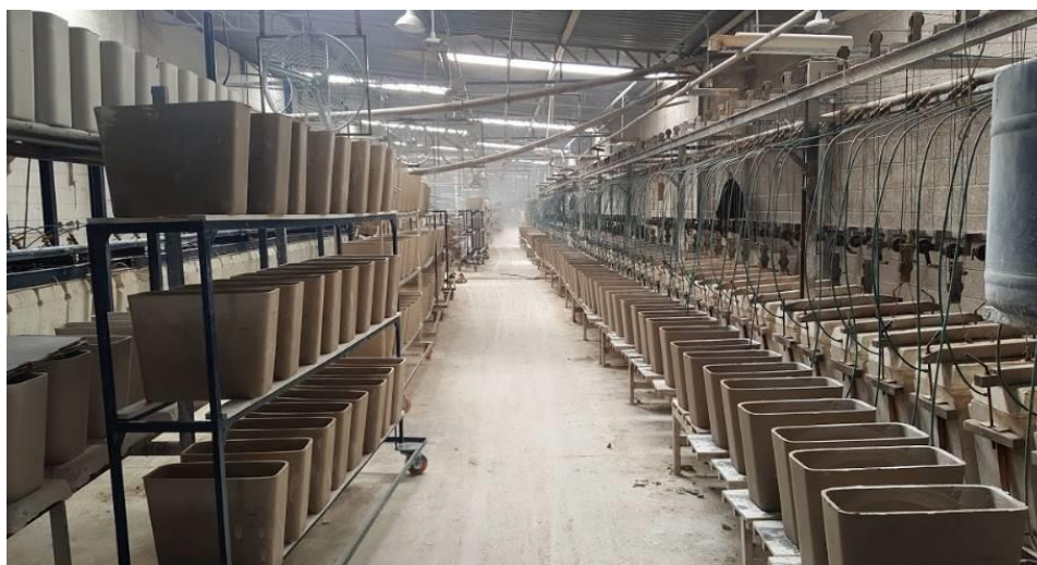
Figura 2.11 – Estação de conformação de caixas acopladas
