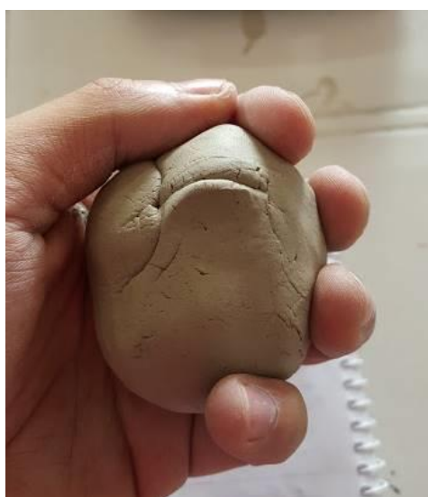
Figura 3.12 – Análise de plasticidade da massa
