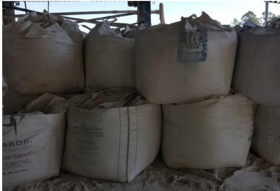
Figura 2.6 – Granito moído (abaixo 300 \mu m) em bags de 1t
