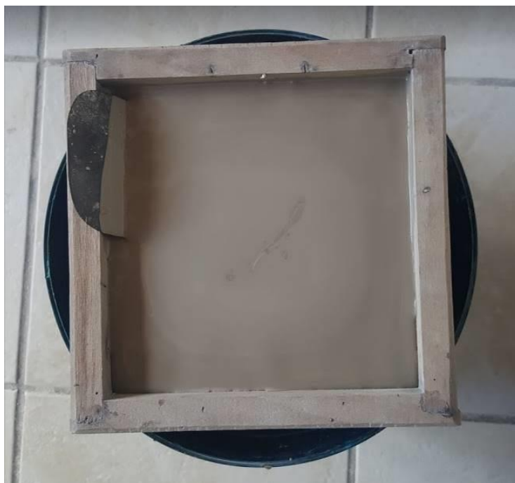
Figura 3.8 – Barbotina sendo passada em peneira de 40#
