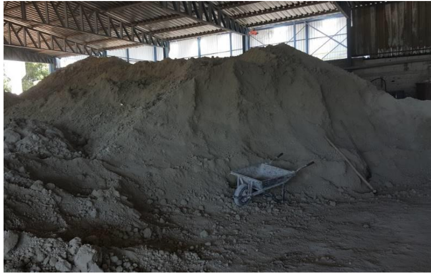
Figura 2.2 – Pilha de filito utilizado para compor a barbotina
