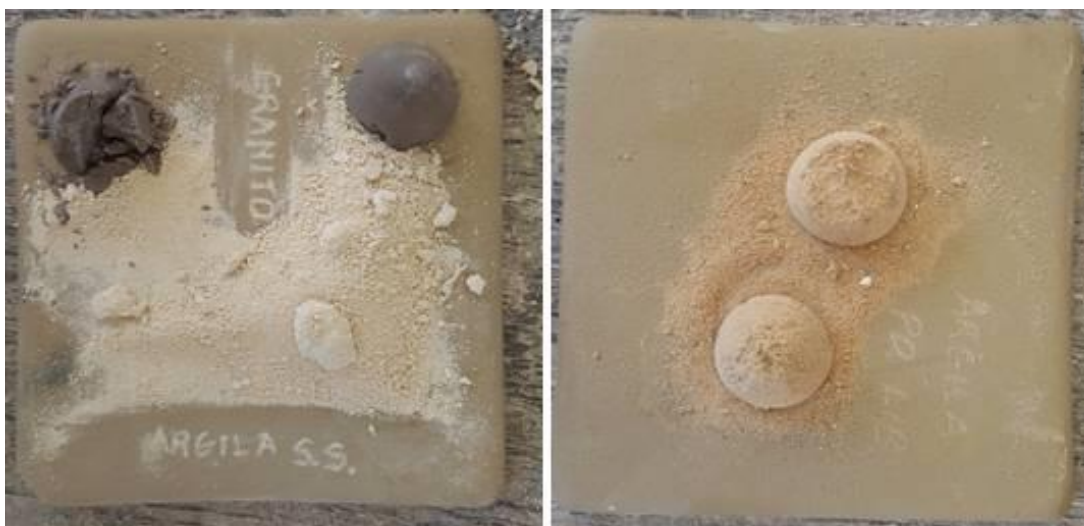
Figura 4.3 – Cones de queima das argilas São Simão (à esquerda inferior) e Padre Libério (à direita)
