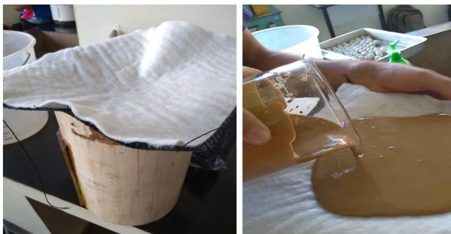
**Figura 3.9 - Testes de desaguamento.**
