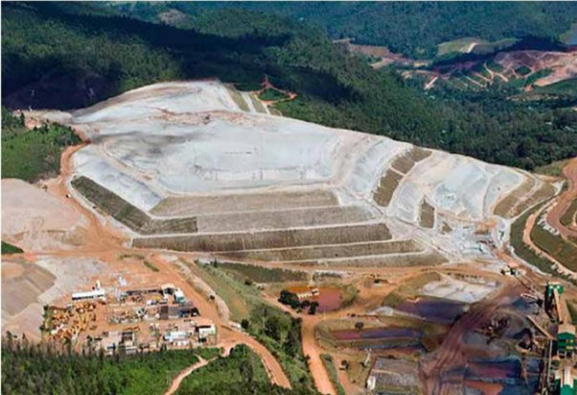
**Figura 2.5 - Deposição de rejeitos em pilhas. Fonte: IBRAM (2016).**
