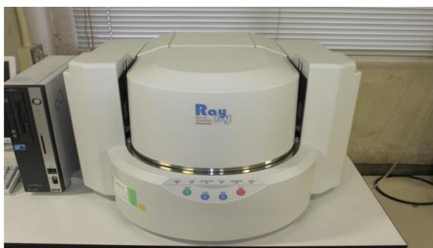
**Figura 3.3 - Analisador químico por fluorescência de raio-x. Fonte: Sambow Adtech Co (2007).**
