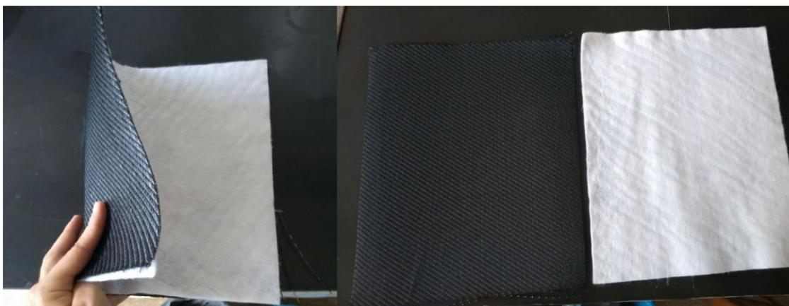
**Figura 3.2 - Amostras de geofibra GT70 utilizadas para testes.**
