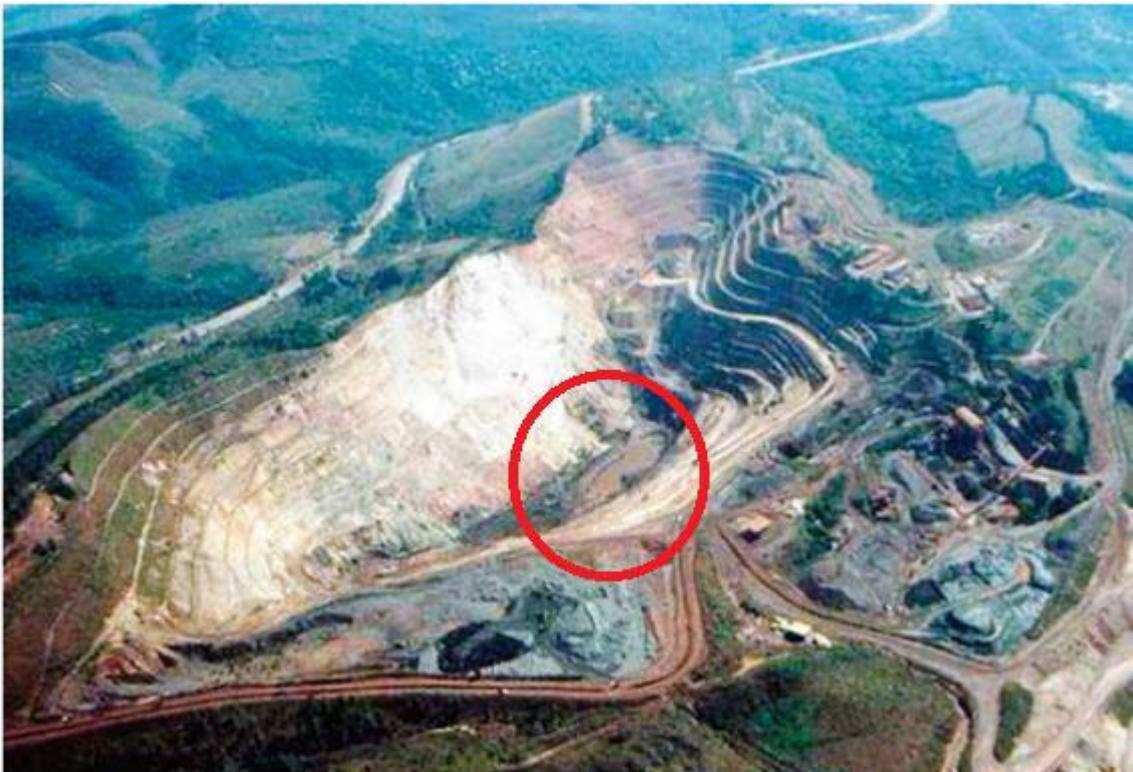
**Figura 2.4 - Aplicação da deposição de rejeitos em cava à céu aberto - Mina de ferro da Mutuca, Nova Lima - MG. Fonte: IBRAM (2016).**
