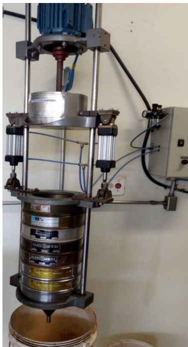
Figura 10: Peneiramento realizado por agitador eletromecânico.
