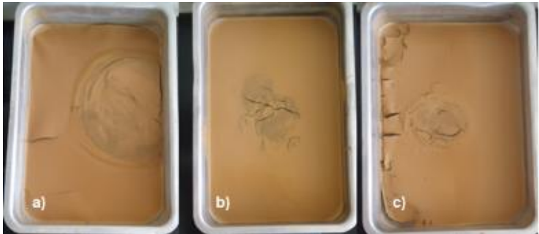
Figura 5.6- Tortas secas para o tecido 4230-T. a) Teste 1; b) Teste 2; c) Teste 3. Fonte: Autoria própria.
