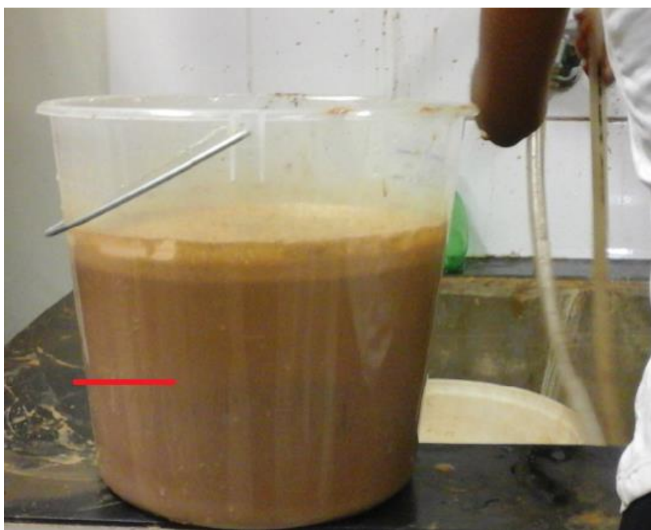
Figura 4.8- Interface entre partículas finas e grossas. Autoria própria.
