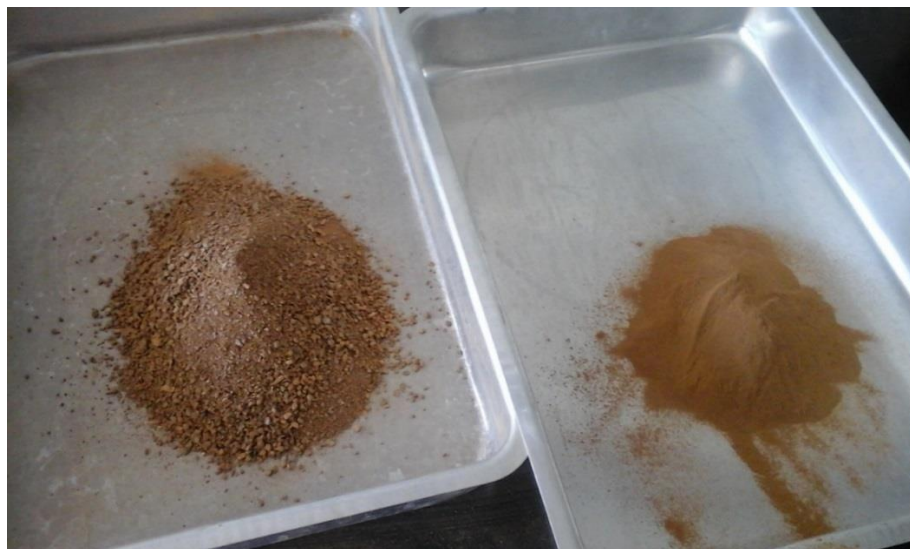
Figura 5.1- Redução de tamanho das partículas com a moagem. Fonte: Autoria própria.
