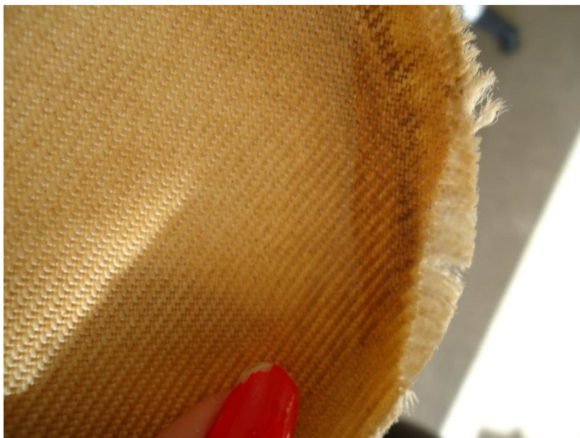
Figura 5.19- Detalhe da descostura do tecido 4520-T após uso. Fonte: Autoria própria.
