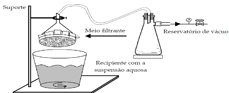
Figura 3.24- Etapa de formação da torta do teste de folha com alimentação por baixo. Fonte: França & Casqueira, 2007.
