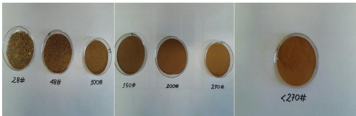
Figura 14 – Produto III apresentando a segregação mineralógica.
