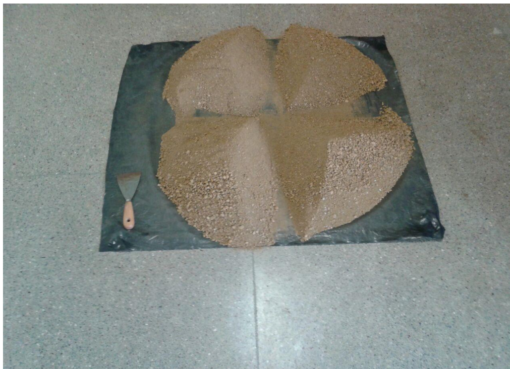
Figura 7 – Quarteamento de amostra.
