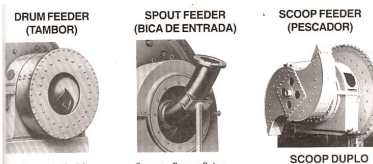
Figura 3 – Tipos de alimentadores em moinhos cilíndricos. Fonte Manual de britagem METSO (2005).
